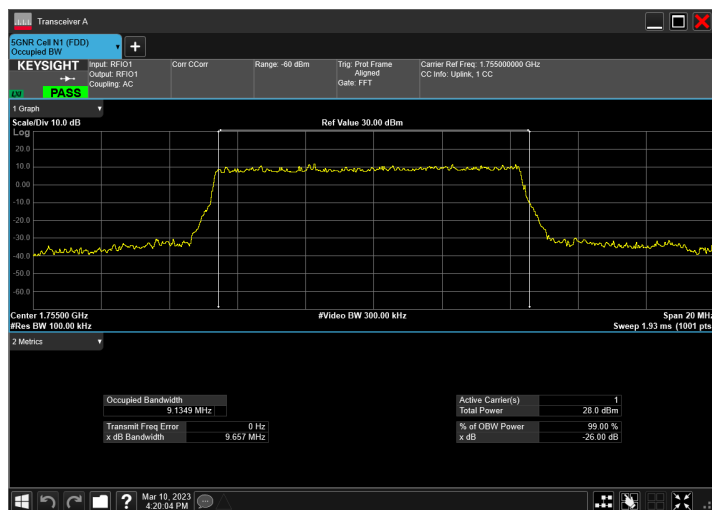
DC_5A_n66A_10MHz|10MHz_15kHz_836.5MHz|1745MHz_Q PSK|DFT-s-OFDM 64 QAM_RB1@50|RB50@0
