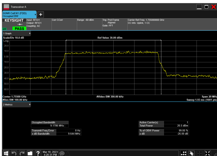
DC_5A_n66A_10MHz|10MHz_15kHz_836.5MHz|1745MHz_Q PSK|DFT-s-OFDM 256 QAM_RB1@50|RB50@0
