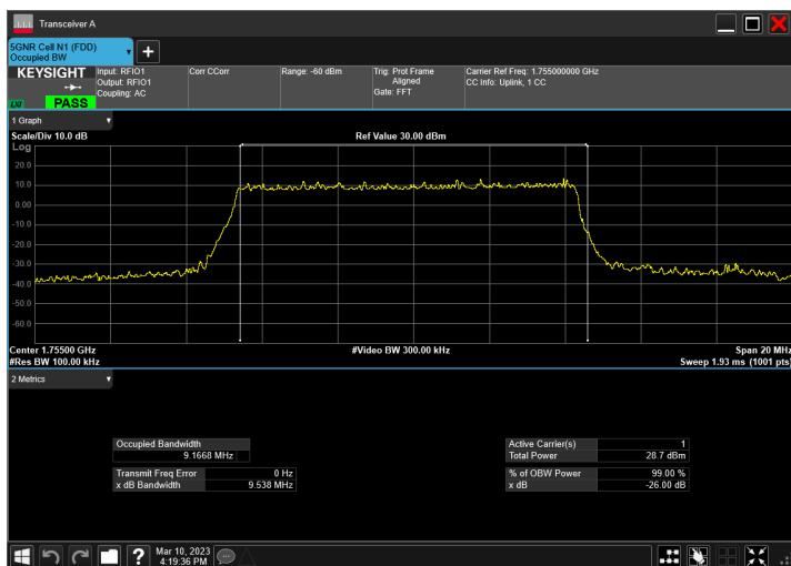
DC_5A_n66A_10MHz|10MHz_15kHz_836.5MHz|1745MHz_Q PSK|DFT-s-OFDM 16 QAM_RB1@50|RB50@0
