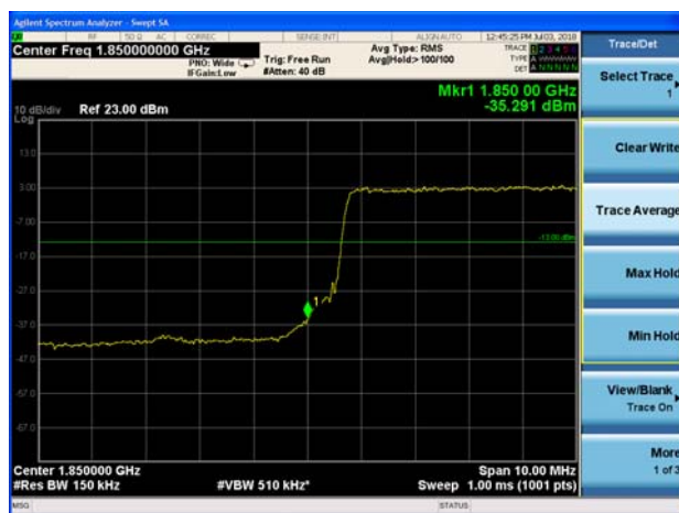
LTE Band 2 20MHz QPSK 1RB CH-Low
