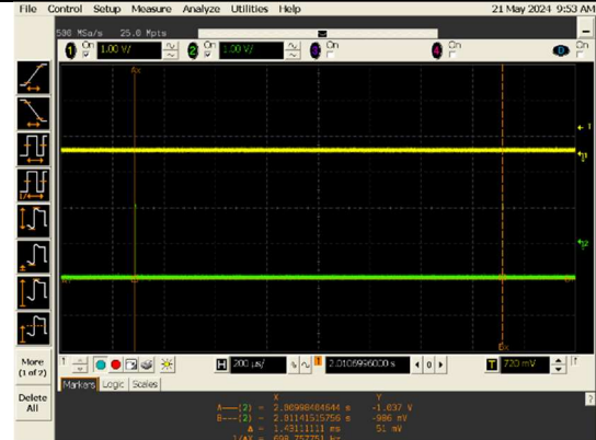
Radar Pulse 0: PRI 1.428 msec
