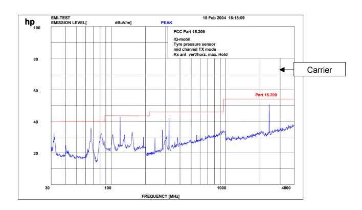
f < 1 GHz: RBW/VBW: 100 kHz  $f \ge 1 \text{ GHz}: RBW/VBW: 1 \text{ MHz}$
