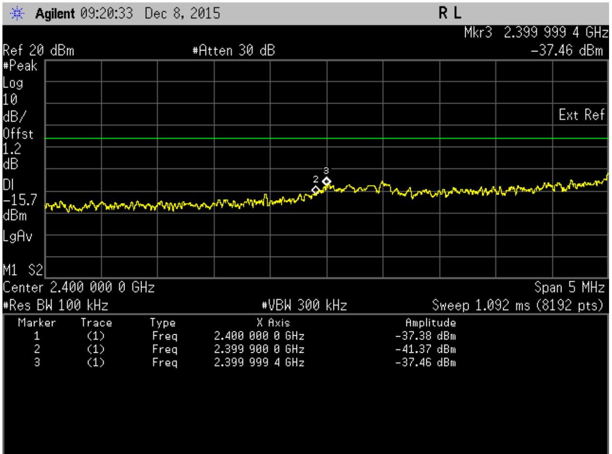
Band Edge (100 kHz). 802.11b Frequency 2412 MHz Band Edge
