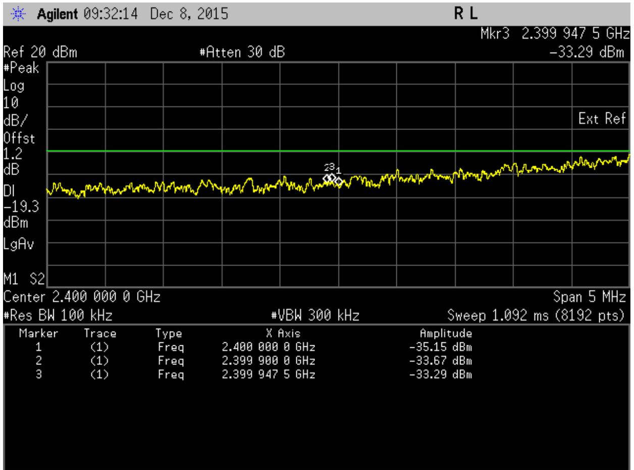
Band Edge (100 kHz). 802.11g Frequency 2412 MHz Band Edge
