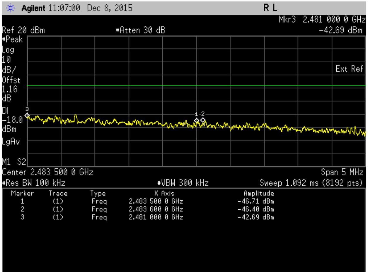
Band Edge (100 kHz). 802.11n\_20 Frequency 2462 MHz Band Edge
