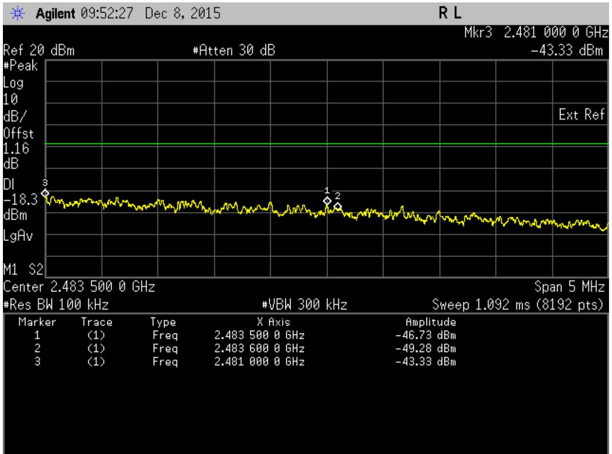
Band Edge (100 kHz). 802.11g Frequency 2462 MHz Band Edge
