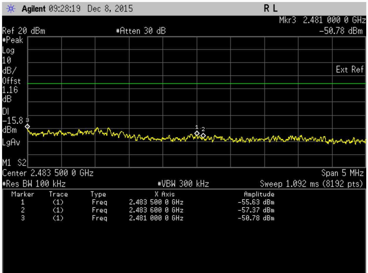
Band Edge (100 kHz). 802.11b Frequency 2462 MHz Band Edge
