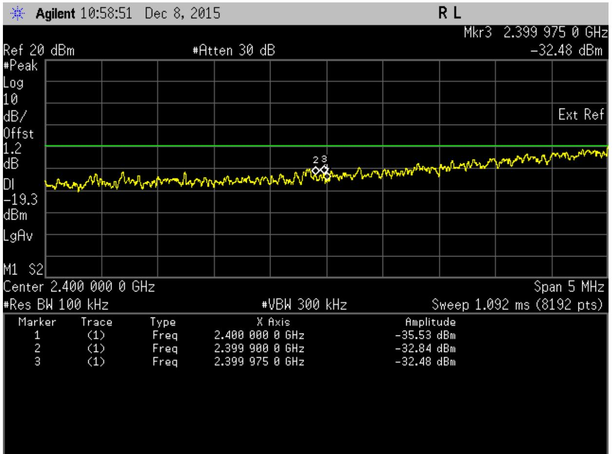
Band Edge (100 kHz). 802.11n\_20 Frequency 2412 MHz Band Edge
