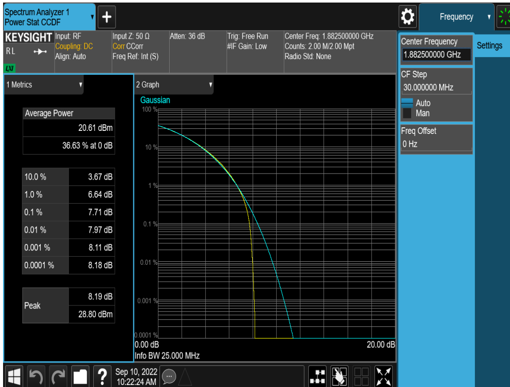
Plot 7-305. PAR Plot (NR Band n25/2 - 25.0MHz CP-OFDM QPSK - Full RB - ANT A)
