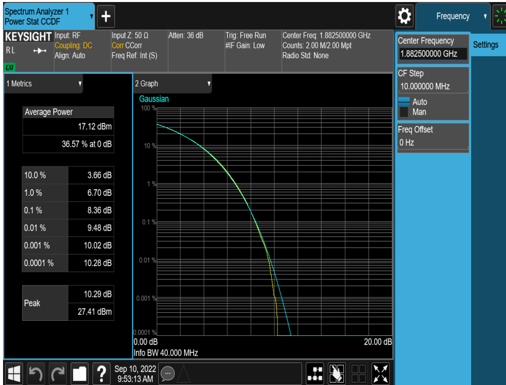
Plot 7-300. PAR Plot (NR Band n25/2 - 40.0MHz CP-OFDM 256-QAM - Full RB - ANT A)
