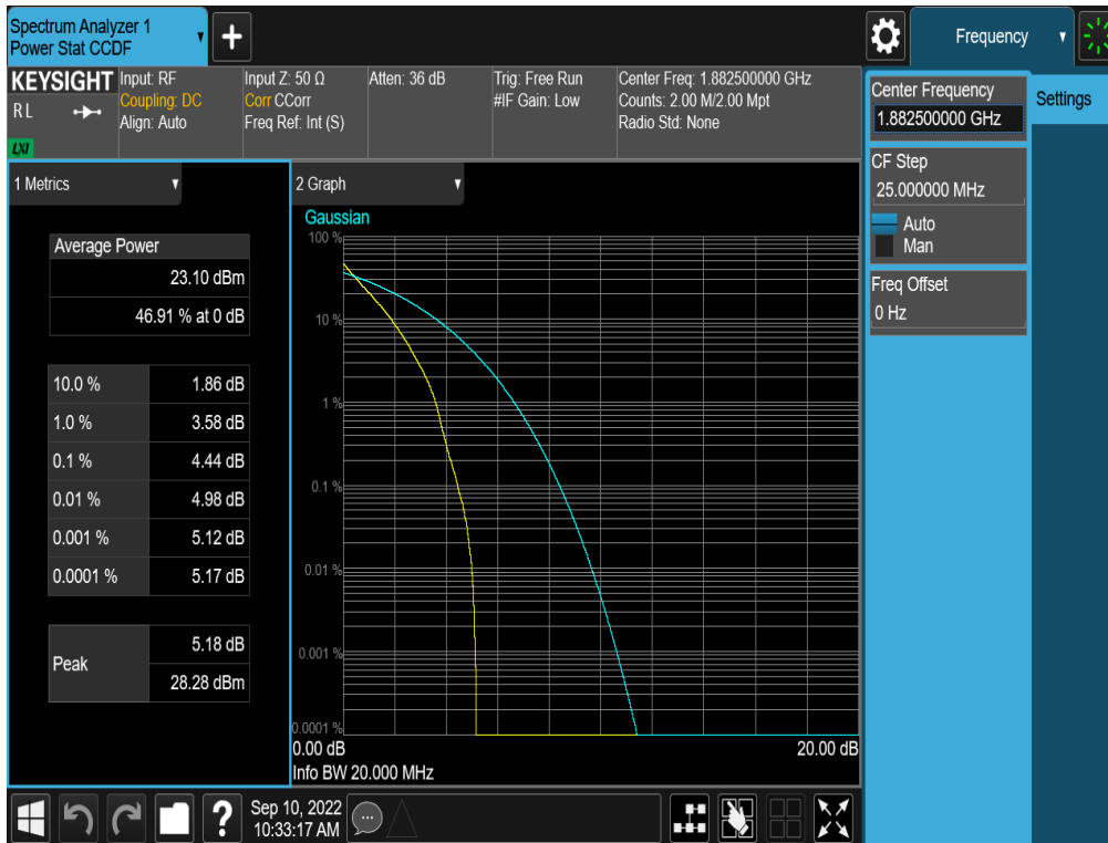
Plot 7-307. PAR Plot (NR Band n25/2 - 20.0MHz DFT-s-OFDM BPSK - Full RB - ANT A)
