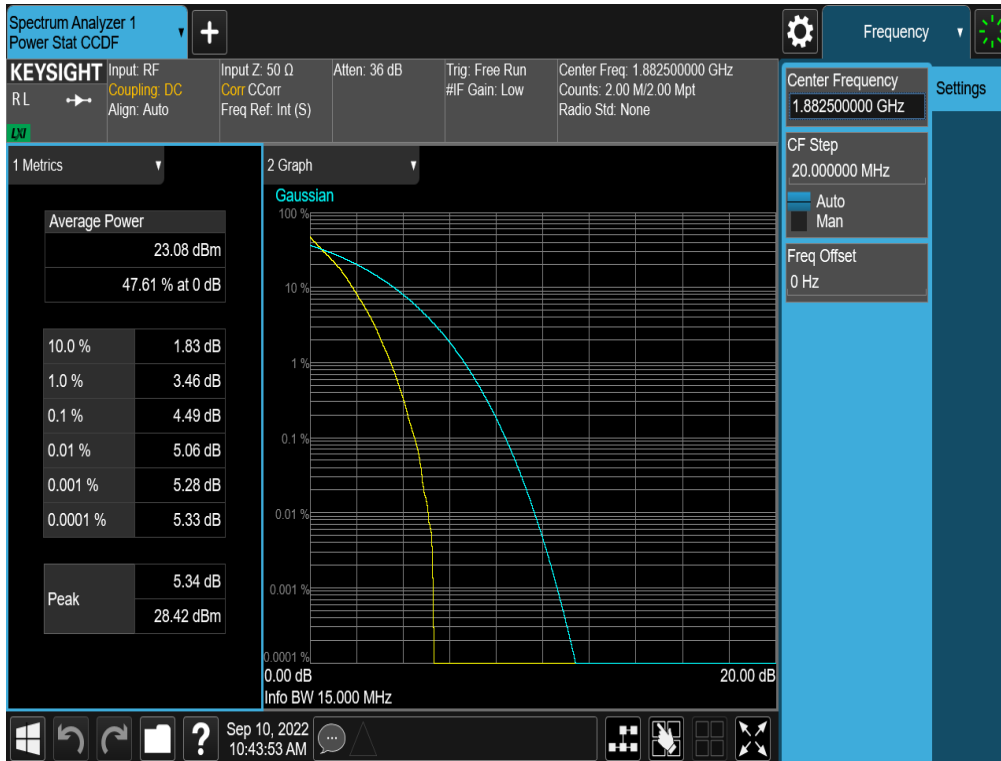
Plot 7-310. PAR Plot (NR Band n25/2 - 15.0MHz DFT-s-OFDM BPSK - Full RB - ANT A)
