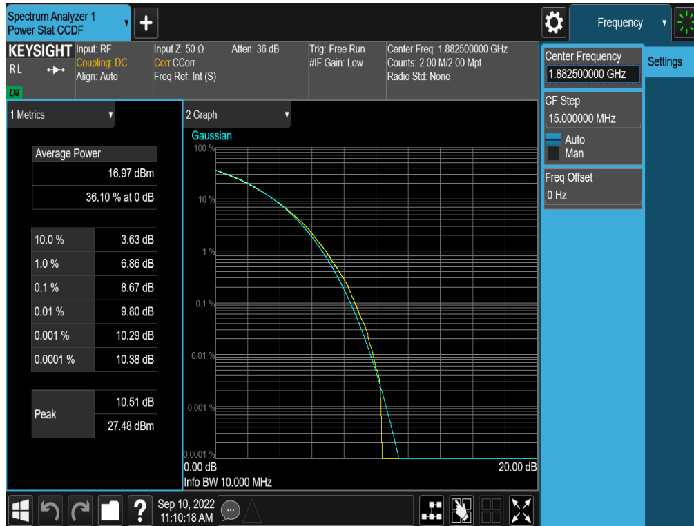
Plot 7-315. PAR Plot (NR Band n25/2 - 10.0MHz CP-OFDM 256-QAM - Full RB - ANT A)
