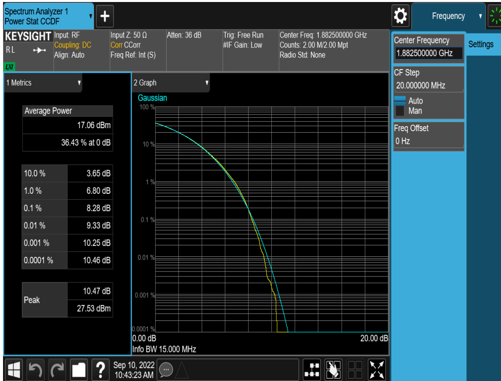
Plot 7-312. PAR Plot (NR Band n25/2 - 15.0MHz CP-OFDM 256-QAM - Full RB - ANT A)
