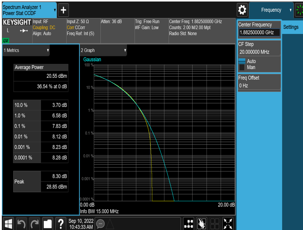
Plot 7-311. PAR Plot (NR Band n25/2 - 15.0MHz CP-OFDM QPSK - Full RB - ANT A)
