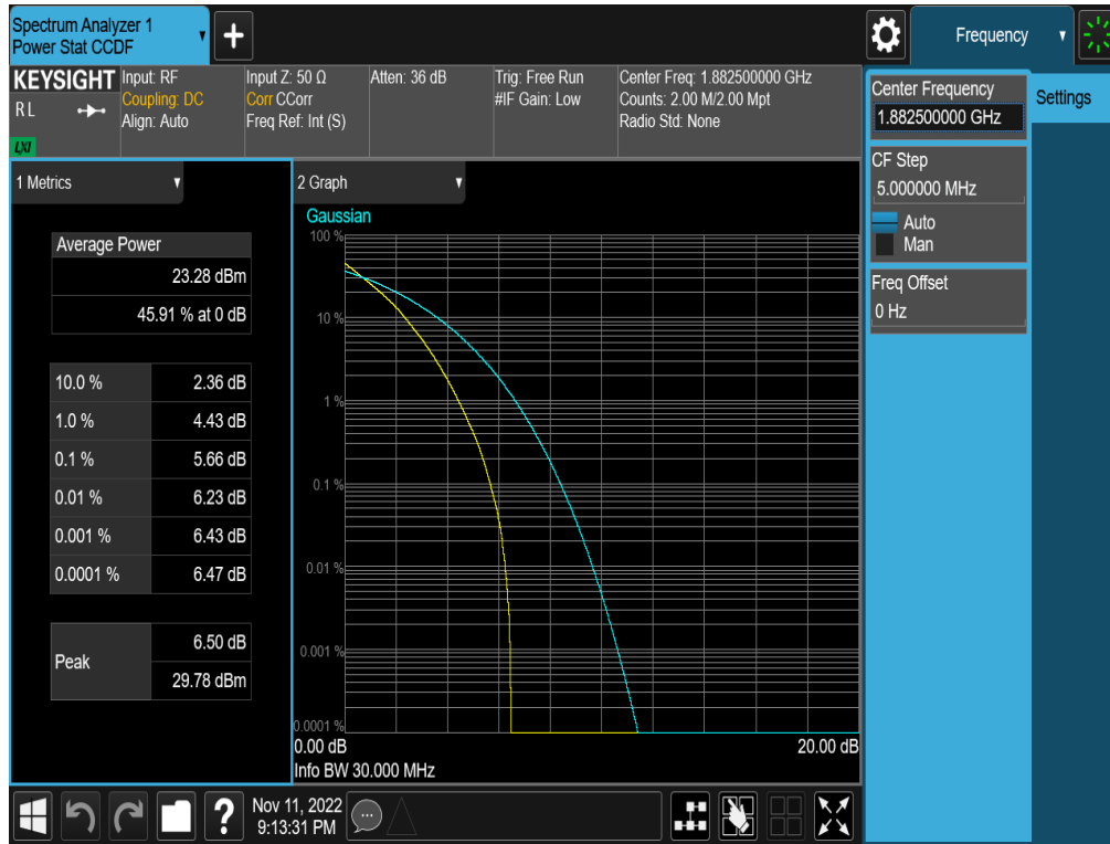
Plot 7-323. PAR Plot (NR Band n25/2 - 30.0MHz CP-OFDM QPSK - Full RB - ANT F)
