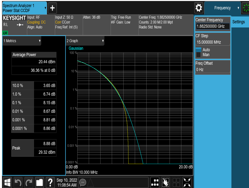
Plot 7-314. PAR Plot (NR Band n25/2 - 10.0MHz CP-OFDM QPSK - Full RB - ANT A)
