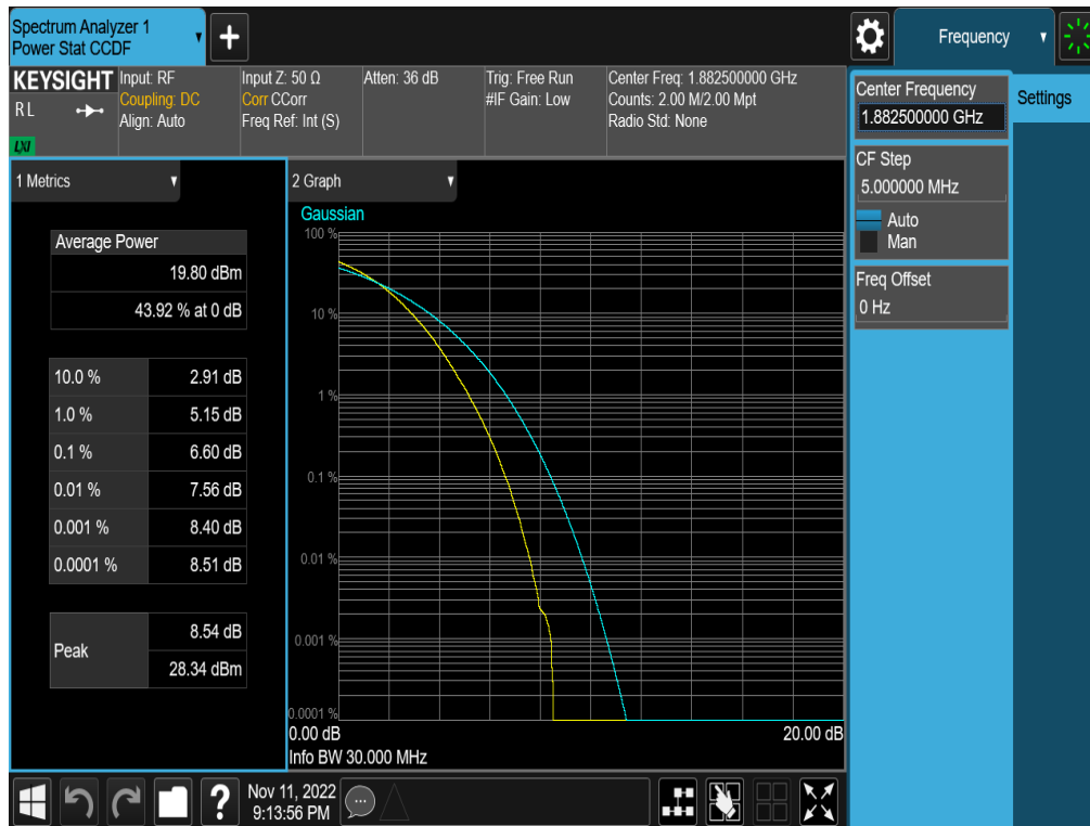
Plot 7-324. PAR Plot (NR Band n25/2 - 30.0MHz CP-OFDM 256-QAM - Full RB - ANT F)
