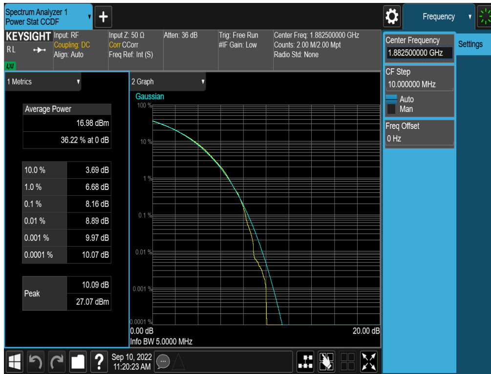
Plot 7-318. PAR Plot (NR Band n25/2 - 5.0MHz CP-OFDM 256-QAM - Full RB - ANT A)
