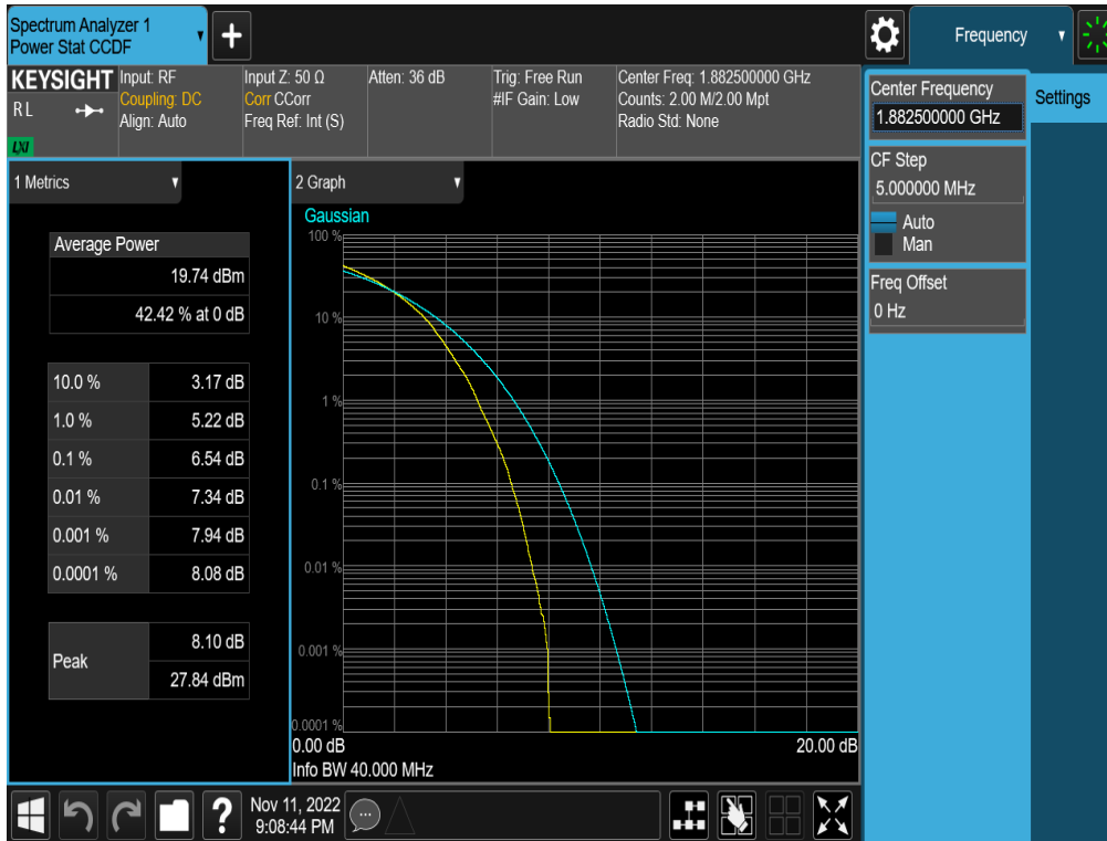
Plot 7-321. PAR Plot (NR Band n25/2 - 40.0MHz CP-OFDM 256-QAM - Full RB - ANT F)
