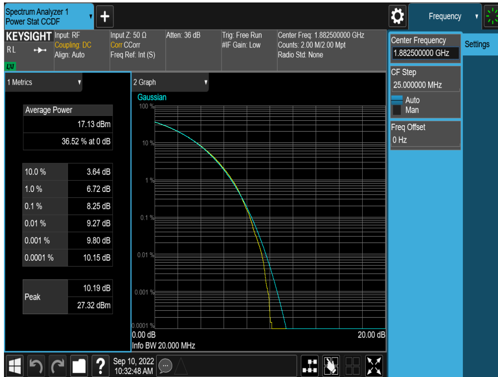
Plot 7-309. PAR Plot (NR Band n25/2 - 20.0MHz CP-OFDM 256-QAM - Full RB - ANT A)
