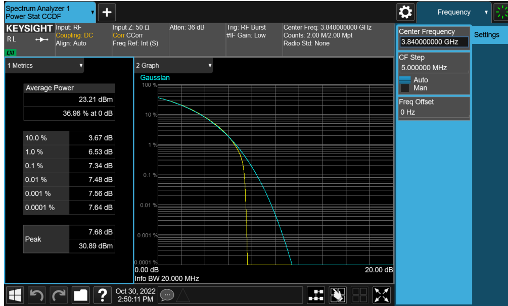
Plot 7-245. PAR Plot (NR Band n77 - C-Band – 20MHz CP-OFDM QPSK - Full RB)
