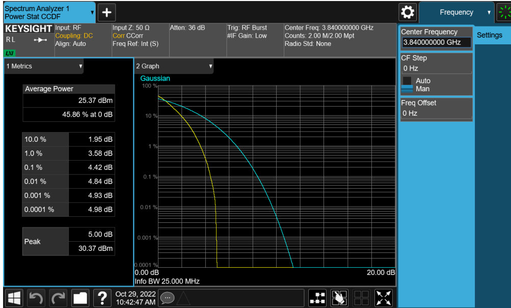
Plot 7-241. PAR Plot (NR Band n77 - C-Band – 25MHz DFT-s-OFDM \pi/2 BPSK - Full RB)
