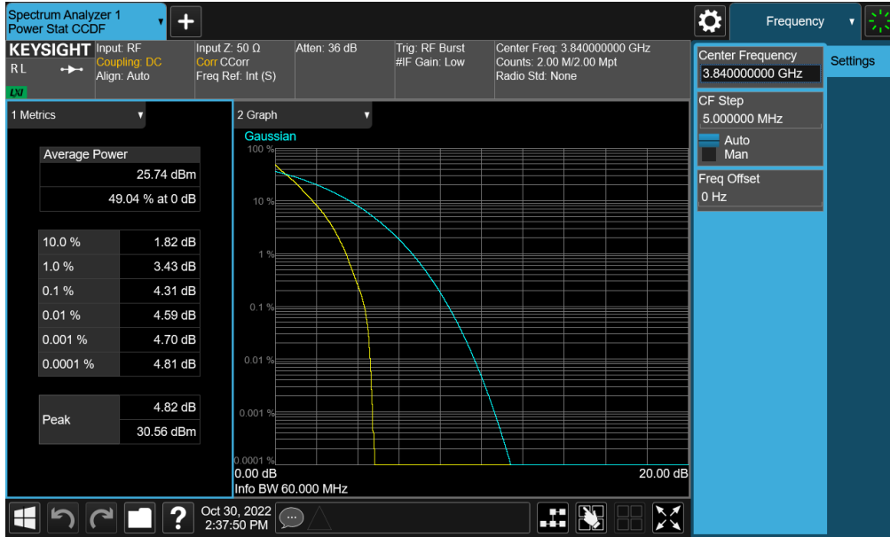
Plot 7-229. PAR Plot (NR Band n77 - C-Band – 60MHz DFT-s-OFDM \pi/2 BPSK - Full RB)
