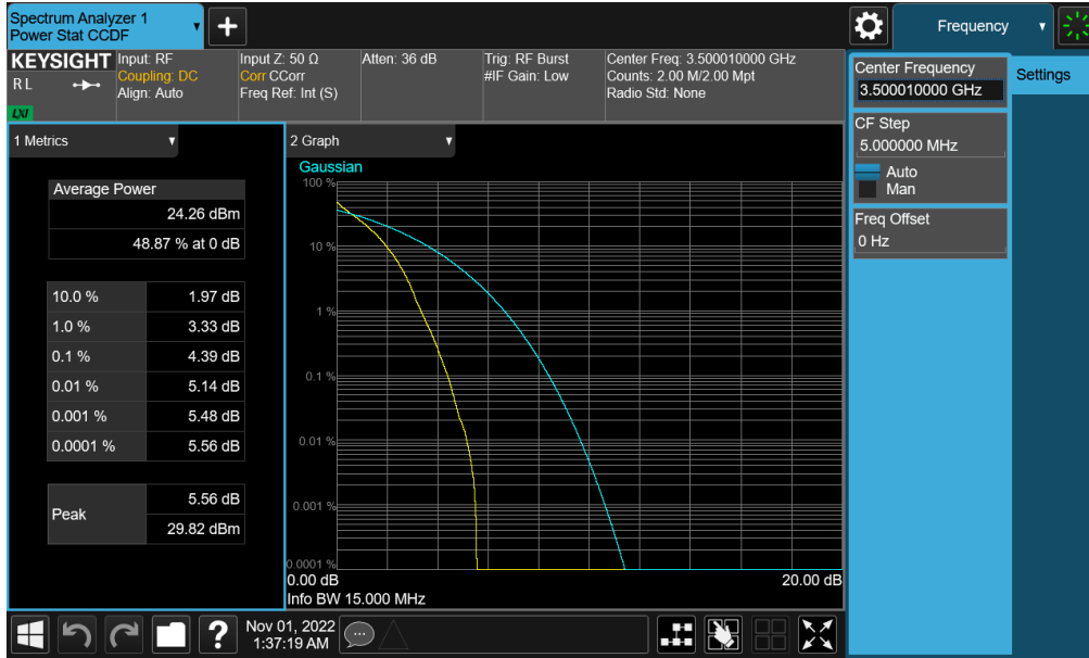
Plot 7-211. PAR Plot (NR Band n77 - DoD Band – 15MHz DFT-s-OFDM \pi/2 BPSK - Full RB)
