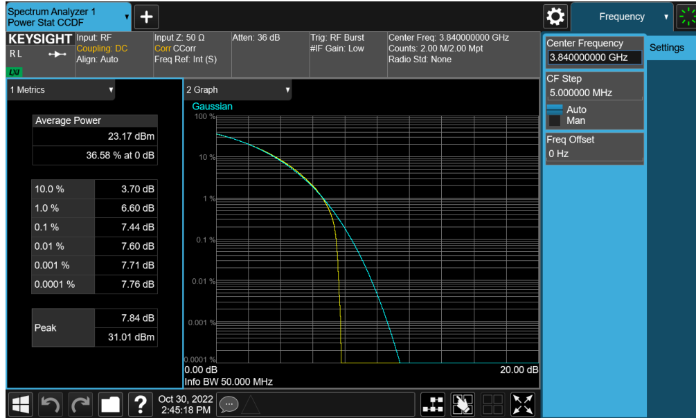
Plot 7-233. PAR Plot (NR Band n77 - C-Band – 50MHz CP-OFDM QPSK - Full RB)
