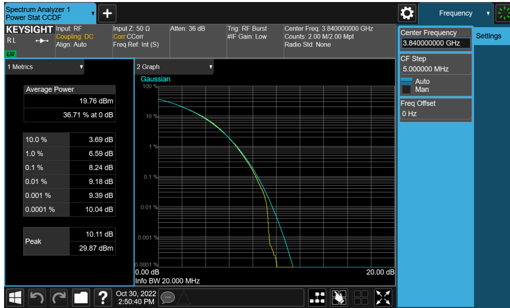
Plot 7-246. PAR Plot (NR Band n77 - C-Band – 20MHz CP-OFDM 256-QAM - Full RB)
