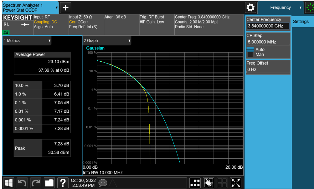
Plot 7-251. PAR Plot (NR Band n77 - C-Band – 10MHz CP-OFDM QPSK - Full RB)
