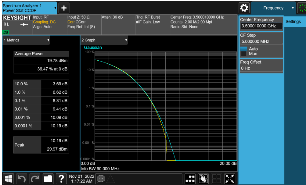
Plot 7-186. PAR Plot (NR Band n77 - DoD Band - 90MHz CP-OFDM 256-QAM - Full RB)
