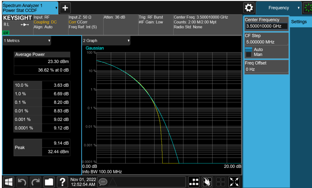
Plot 7-182. PAR Plot (NR Band n77 - DoD Band – 100MHz CP-OFDM QPSK - Full RB)
