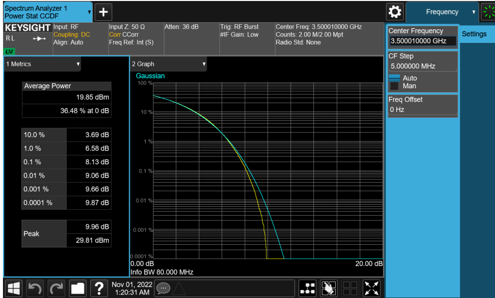
Plot 7-189. PAR Plot (NR Band n77 - DoD Band – 80MHz CP-OFDM 256-QAM - Full RB)
