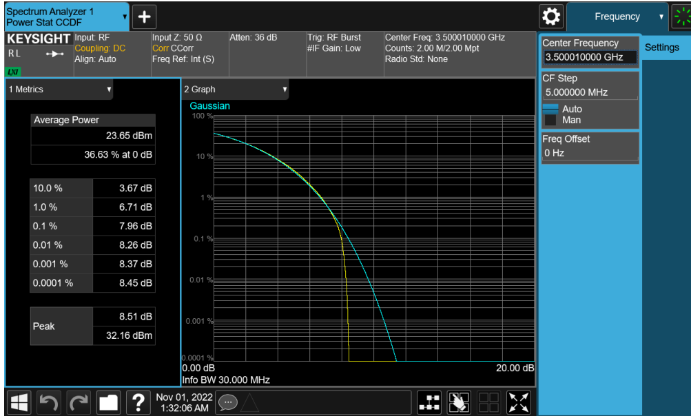
Plot 7-203. PAR Plot (NR Band n77 - DoD Band – 30MHz CP-OFDM QPSK - Full RB)
