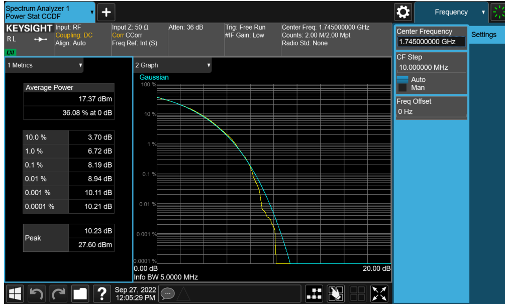
Plot 7-457. PAR Plot (NR Band n66 - 5.0MHz CP-OFDM 256-QAM - Full RB - Ant F)
