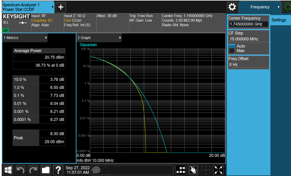
Plot 7-453. PAR Plot (NR Band n66 - 10.0MHz CP-OFDM QPSK - Full RB - Ant F)
