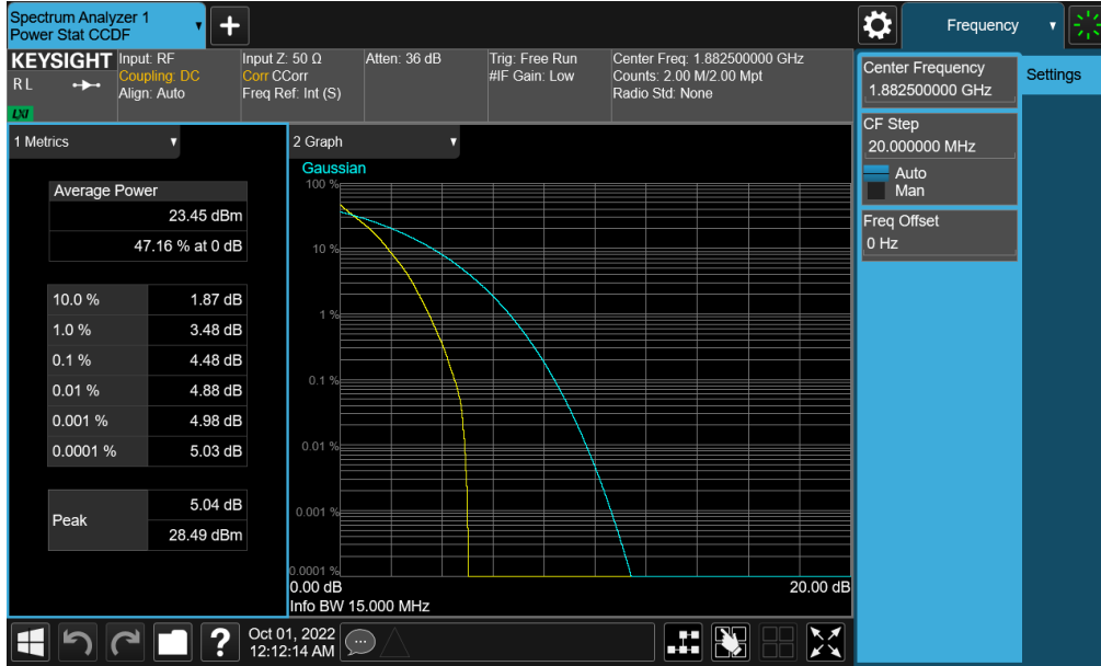
Plot 7-334. PAR Plot (NR Band n25/2 - 15.0MHz DFT-s-OFDM BPSK - Full RB - Ant F)
