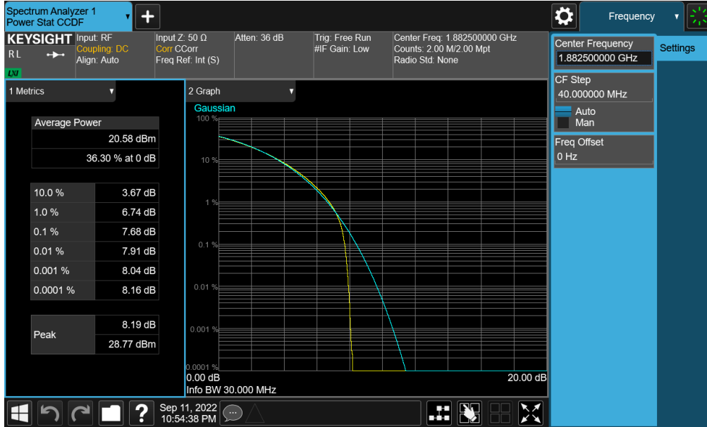
Plot 7-290. PAR Plot (NR Band n25 - 30.0MHz CP-OFDM QPSK - Full RB - Ant A)
