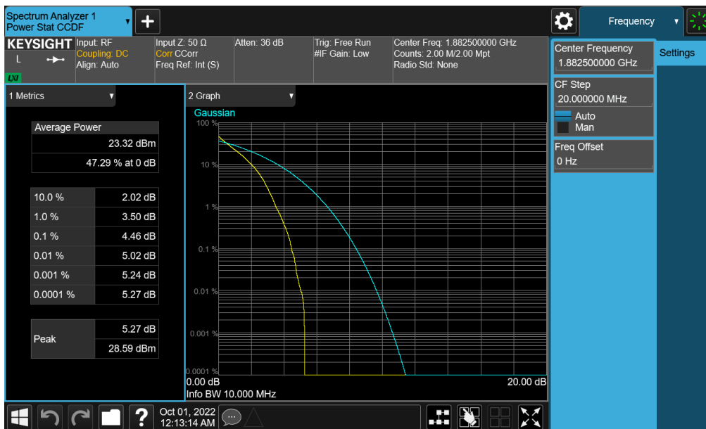
Plot 7-337. PAR Plot (NR Band n25/2 - 10.0MHz DFT-s-OFDM BPSK - Full RB - Ant F)
