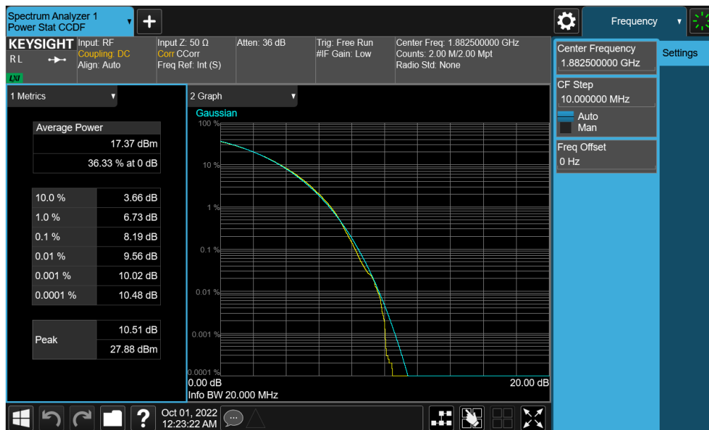
Plot 7-333. PAR Plot (NR Band n25/2 - 20.0MHz CP-OFDM 256-QAM - Full RB - Ant F)
