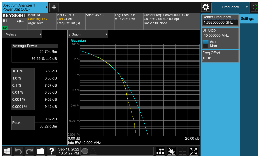
Plot 7-287. PAR Plot (NR Band n25 - 40.0MHz CP-OFDM QPSK - Full RB - Ant A)
