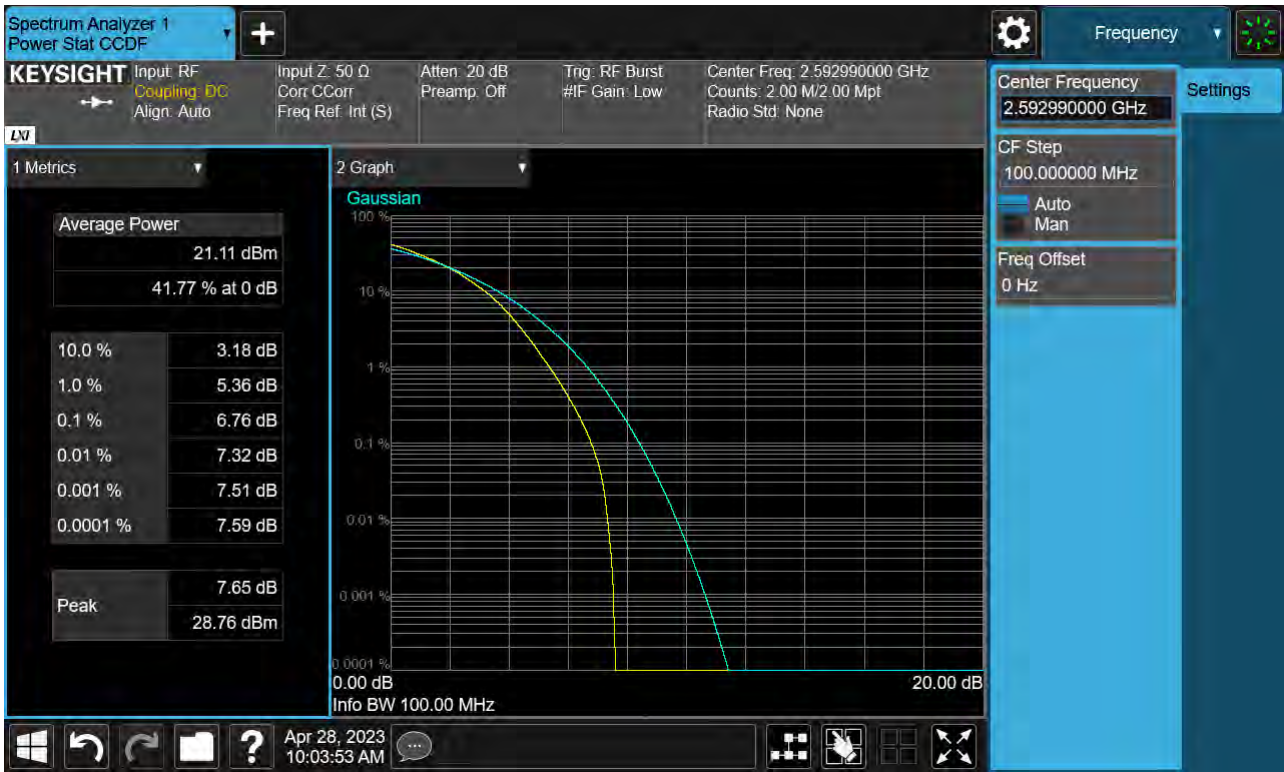
Sub6 n41. PAR Plot (100 M BW_Ch.518598_64QAM)
