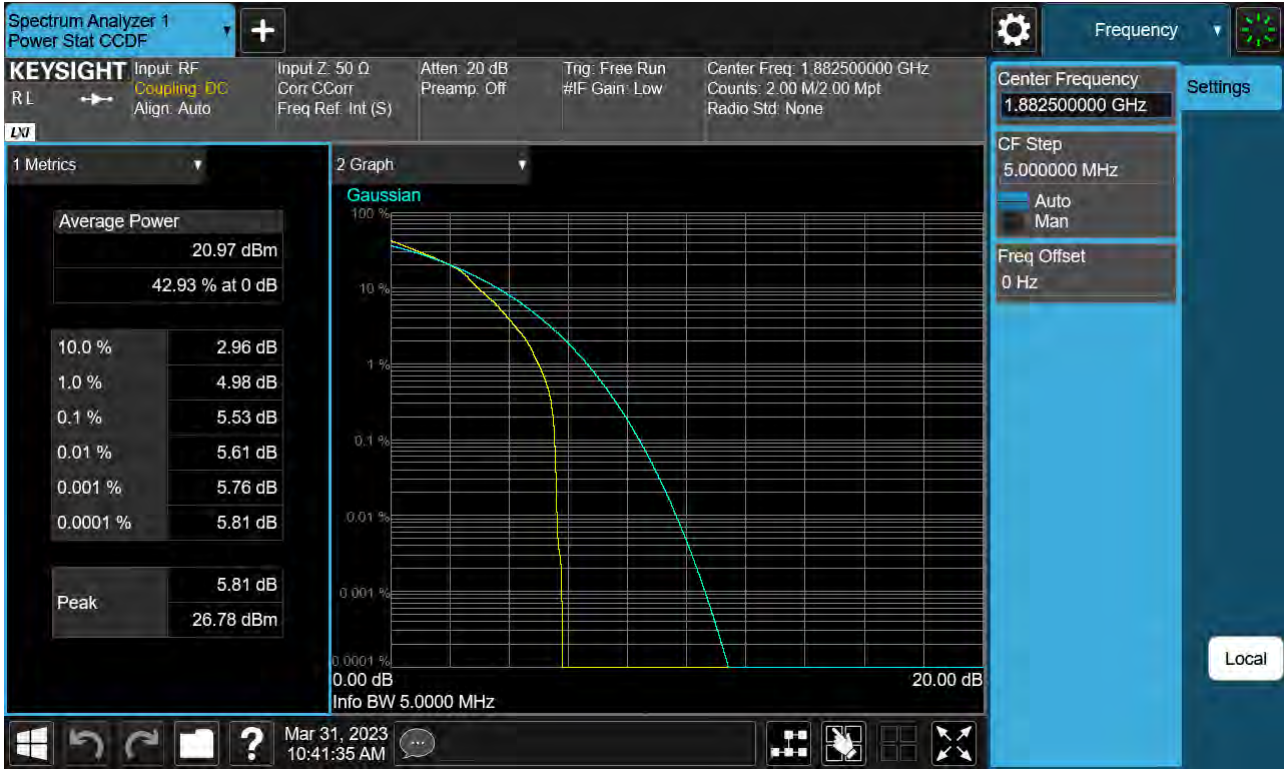
Sub6 n25(2). PAR Plot (5 M BW Ch.376500 16QAM_ Full RB _0 )
