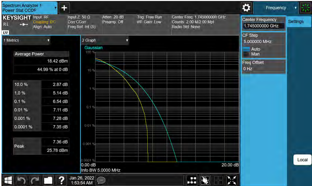
Sub6 n66. PAR Plot (5 M BW_Ch.349000_256QAM_Full RB)
