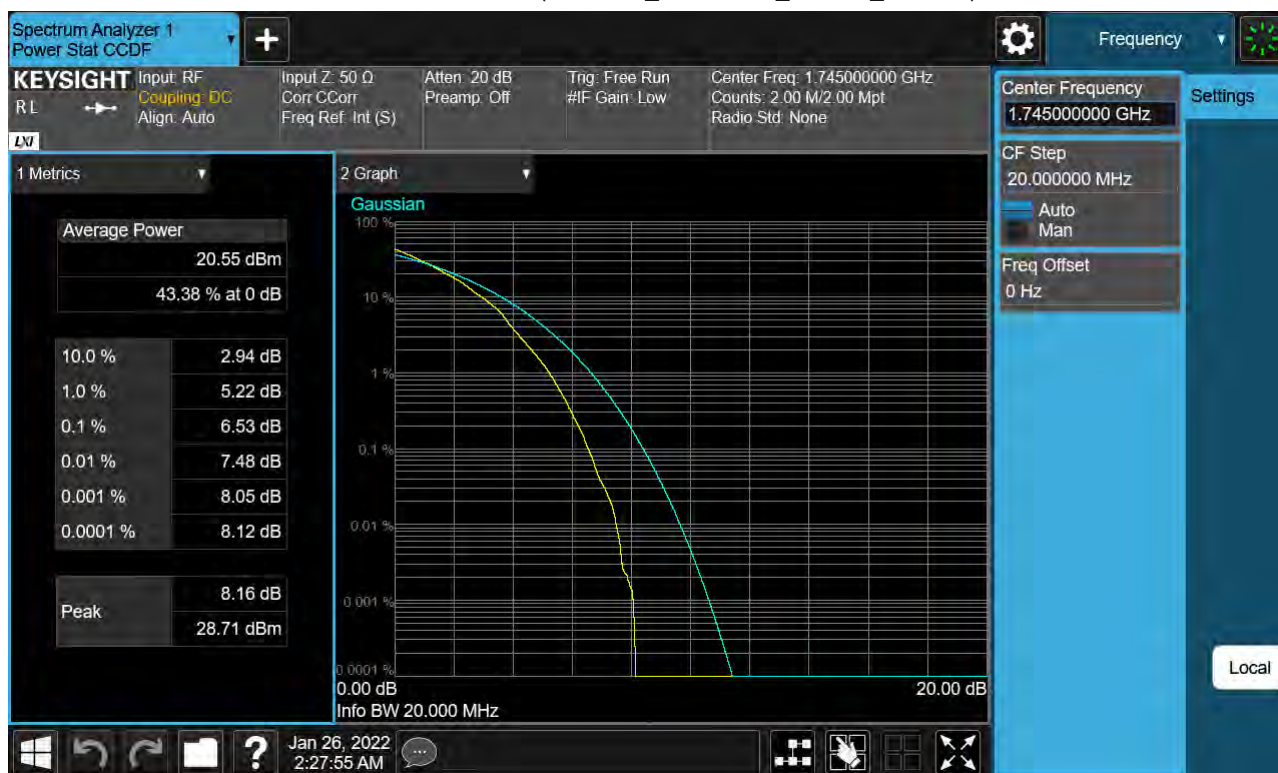
Sub6 n66. PAR Plot (20 M BW_Ch.349000_64QAM_Full RB)
