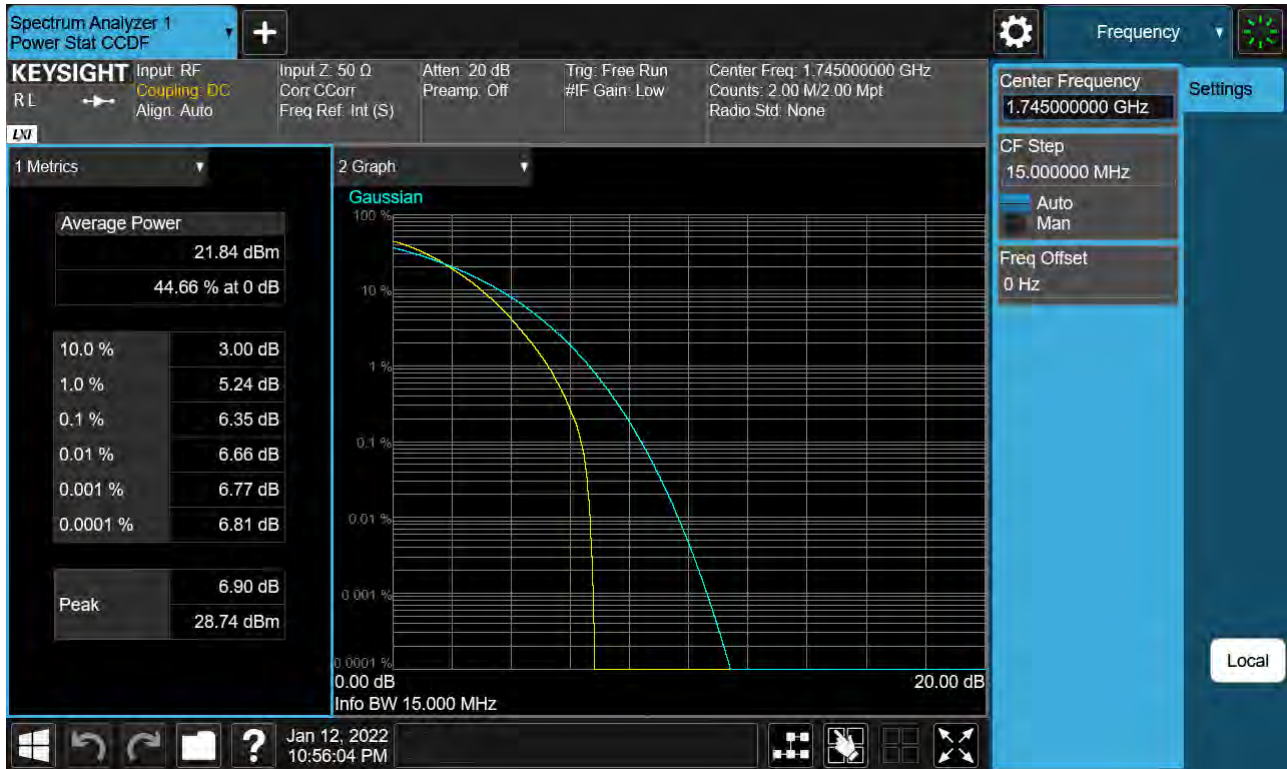
Sub6 n66. PAR Plot (15 M BW_Ch.349000_64QAM_Full RB)
