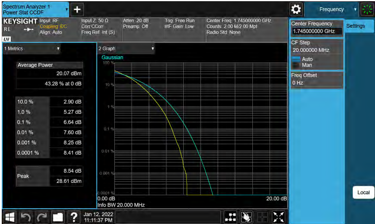
Sub6 n66. PAR Plot (20 M BW_Ch.349000_256QAM_Full RB)
