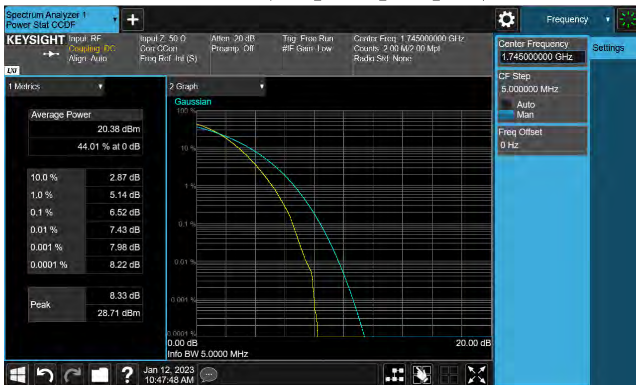
Sub6 n66. PAR Plot (5 M BW_Ch.349000_256QAM_Full RB)
