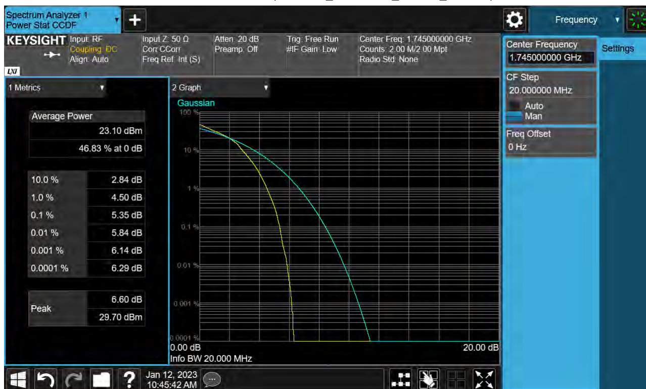
Sub6 n66. PAR Plot (20 M BW_Ch.349000_16QAM_Full RB)
