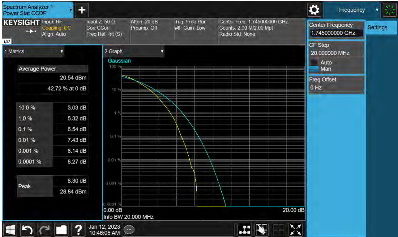
Sub6 n66. PAR Plot (20 M BW_Ch.349000_256QAM_Full RB)
