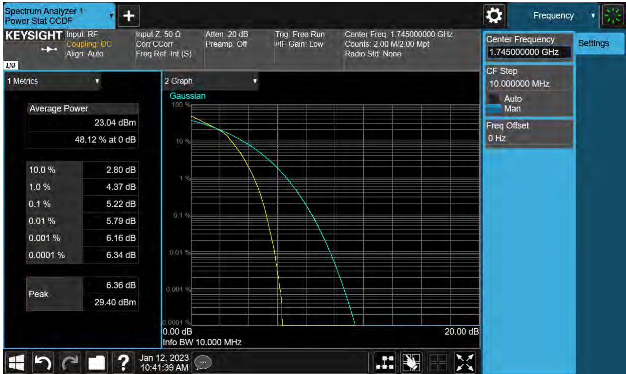
Sub6 n66. PAR Plot (10 M BW_Ch.349000_16QAM_Full RB)
