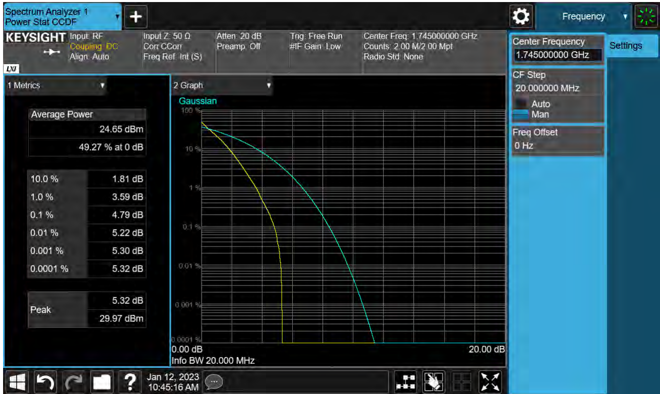
Sub6 n66. PAR Plot (20 M BW_Ch.349000_ BPSK_ Full RB)
