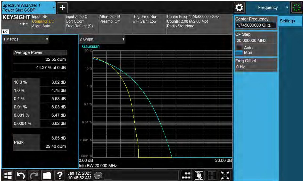
Sub6 n66. PAR Plot (20 M BW_Ch.349000_64QAM_Full RB)
