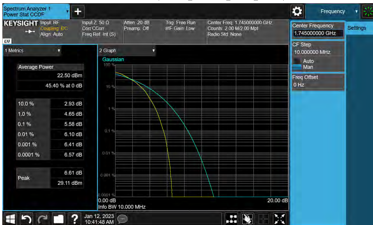
Sub6 n66. PAR Plot (10 M BW_Ch.349000_64QAM_Full RB)
