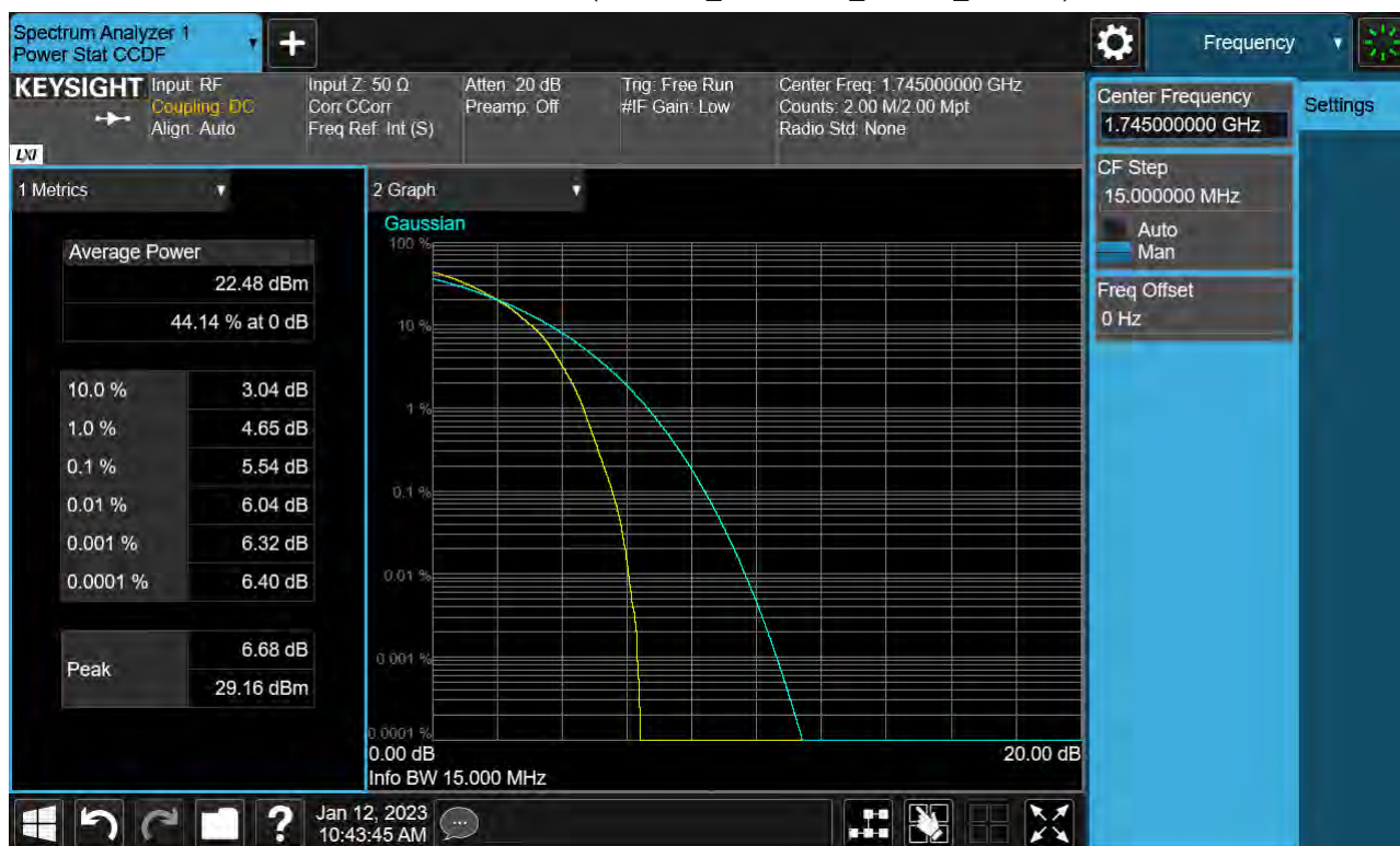
Sub6 n66. PAR Plot (15 M BW_Ch.349000_64QAM_Full RB)
