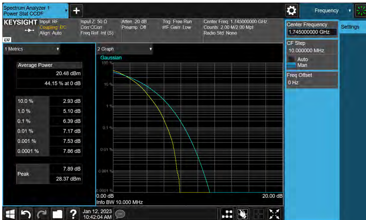
Sub6 n66. PAR Plot (10 M BW_Ch.349000_256QAM_Full RB)
