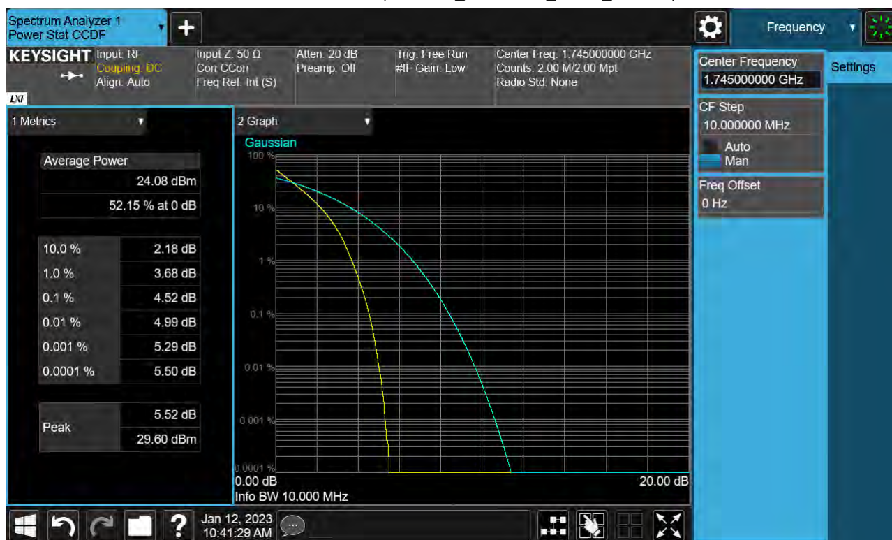
Sub6 n66. PAR Plot (10 M BW_Ch.349000_QPSK_Full RB)
