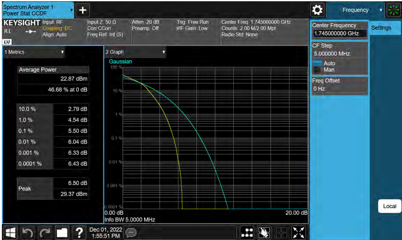
Sub6 n66. PAR Plot (5 M BW_Ch.349000_16QAM_Full RB)
