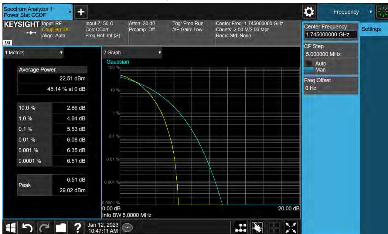
Sub6 n66. PAR Plot (5 M BW_Ch.349000_64QAM_Full RB)
