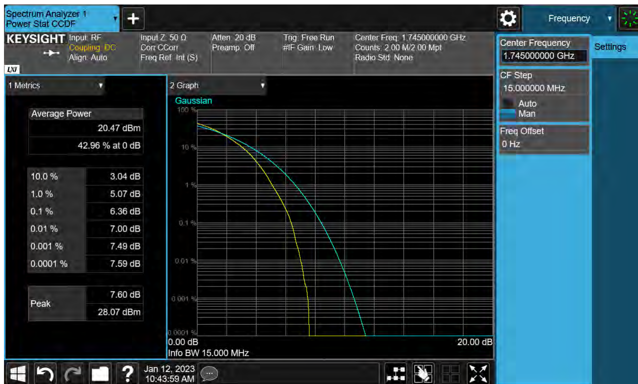
Sub6 n66. PAR Plot (15 M BW_Ch.349000_256QAM_Full RB)
