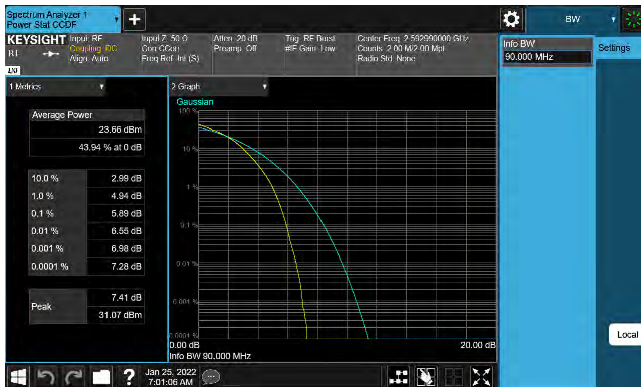
Sub6 n41. PAR Plot (90 M BW_Ch.518598_16QAM)
