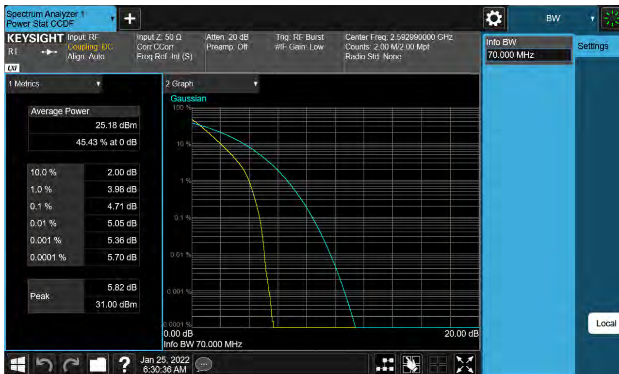
Sub6 n41. PAR Plot (70 M BW_Ch.518598_BPSK)
