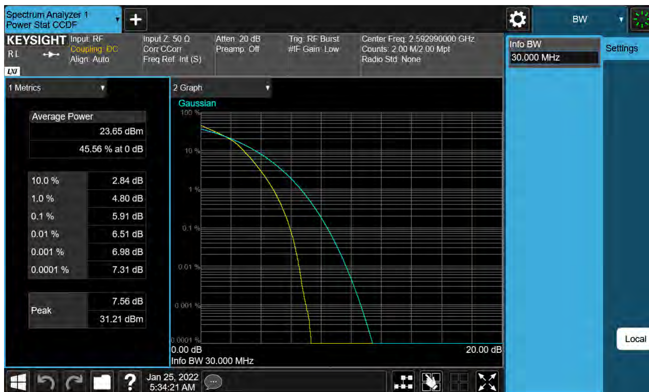
Sub6 n41. PAR Plot (30 M BW_Ch.518598_16QAM)
