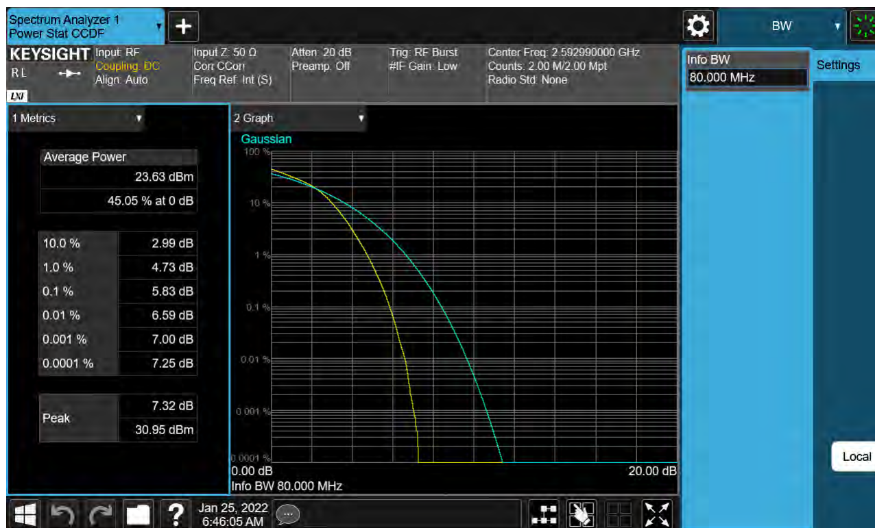
Sub6 n41. PAR Plot (80 M BW_Ch.518598_16QAM)
