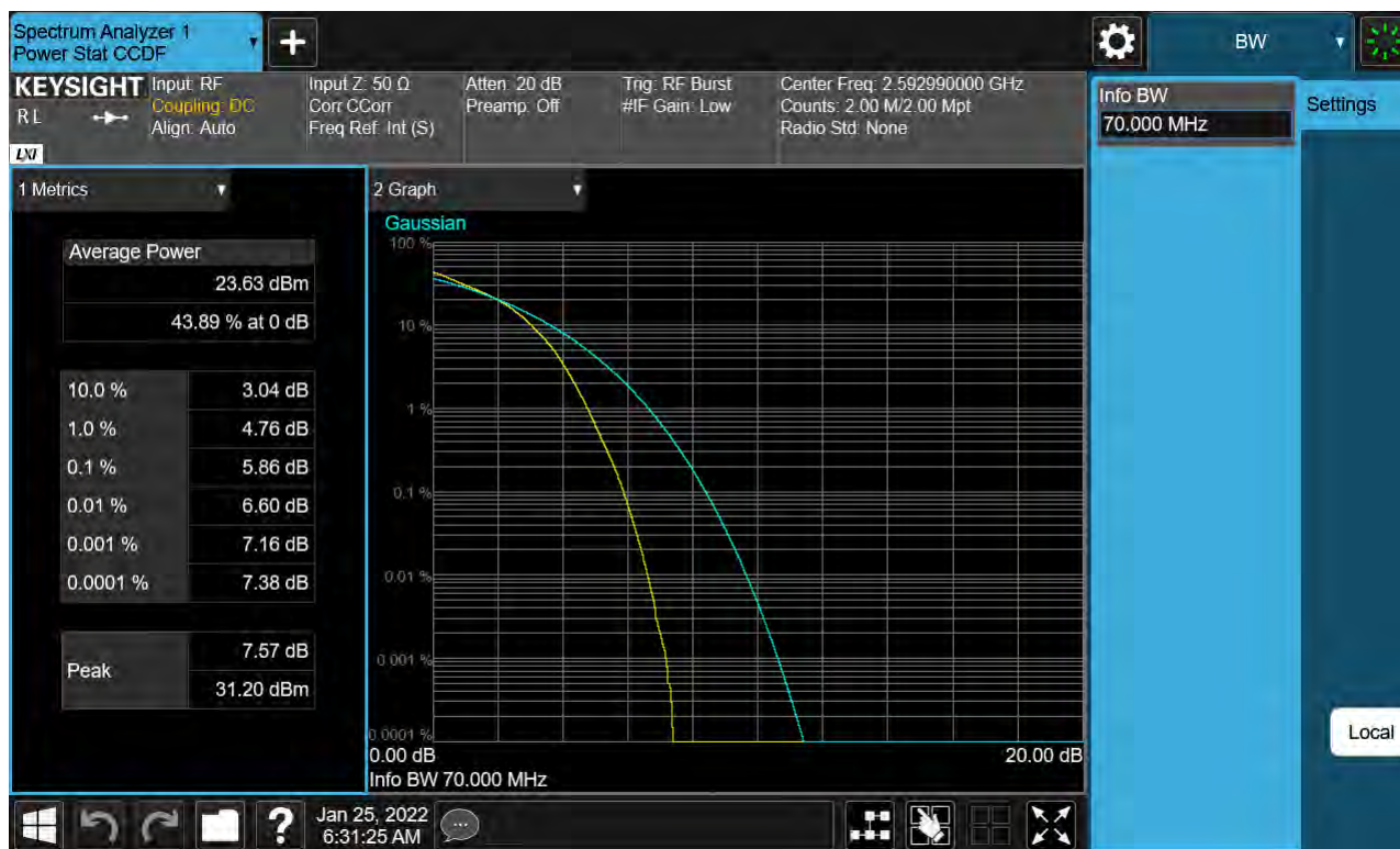
Sub6 n41. PAR Plot (70 M BW_Ch.518598_16QAM)
