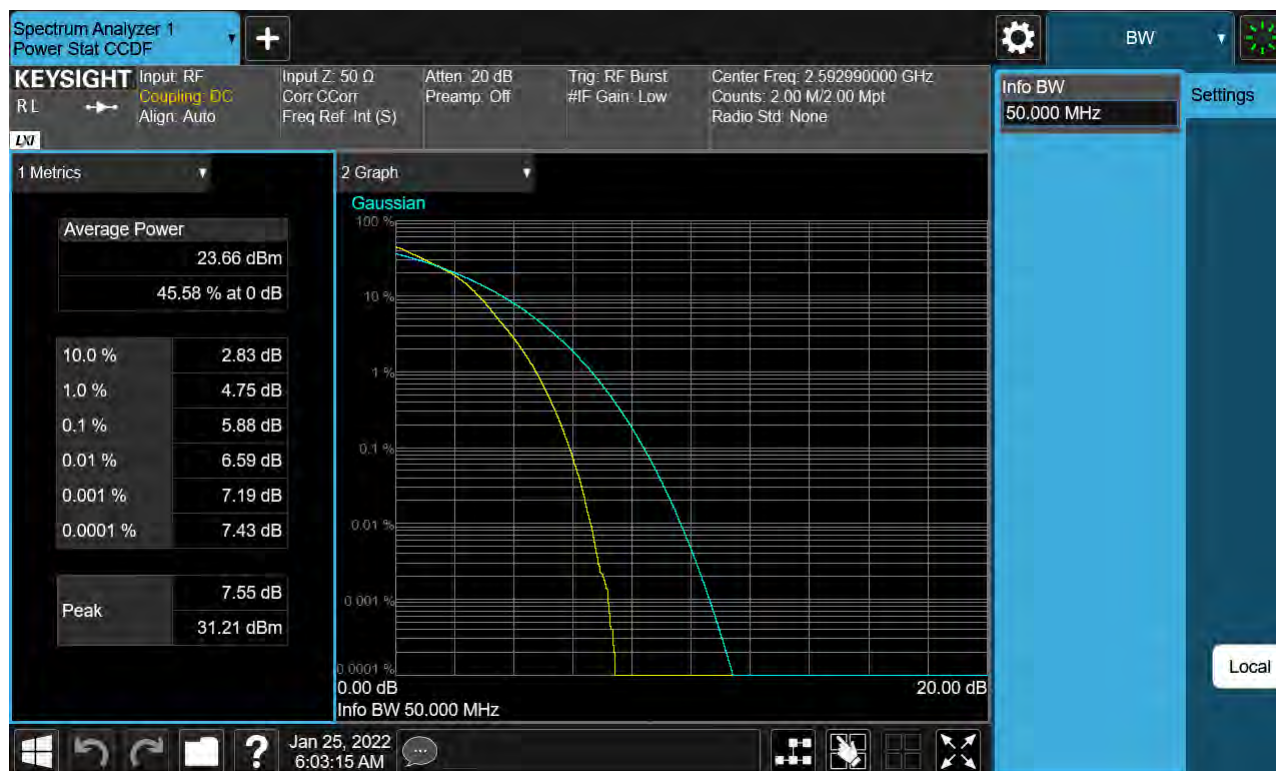
Sub6 n41. PAR Plot (50 M BW_Ch.518598_16QAM)
