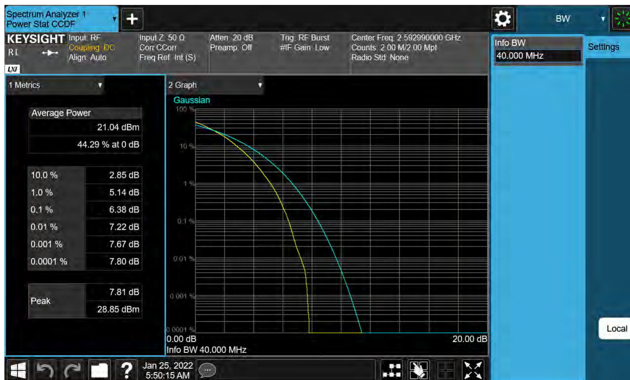
Sub6 n41. PAR Plot (40 M BW_Ch.518598_256QAM)
