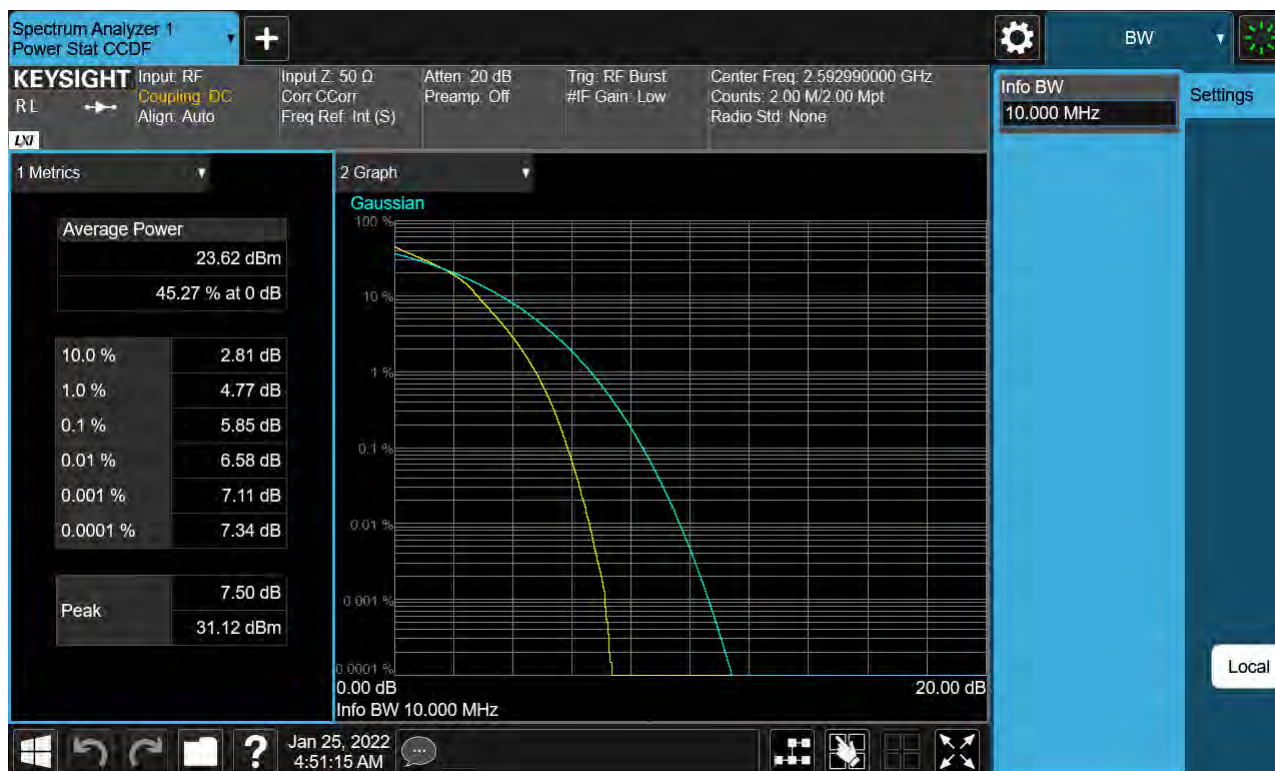
Sub6 n41. PAR Plot (10 M BW_Ch.518598_16QAM)
