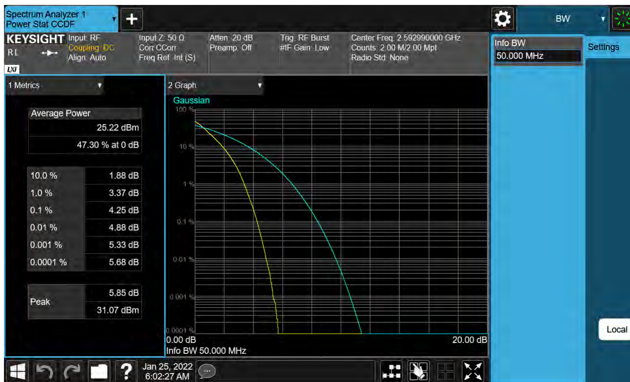
Sub6 n41. PAR Plot (50 M BW_Ch.518598_BPSK)
