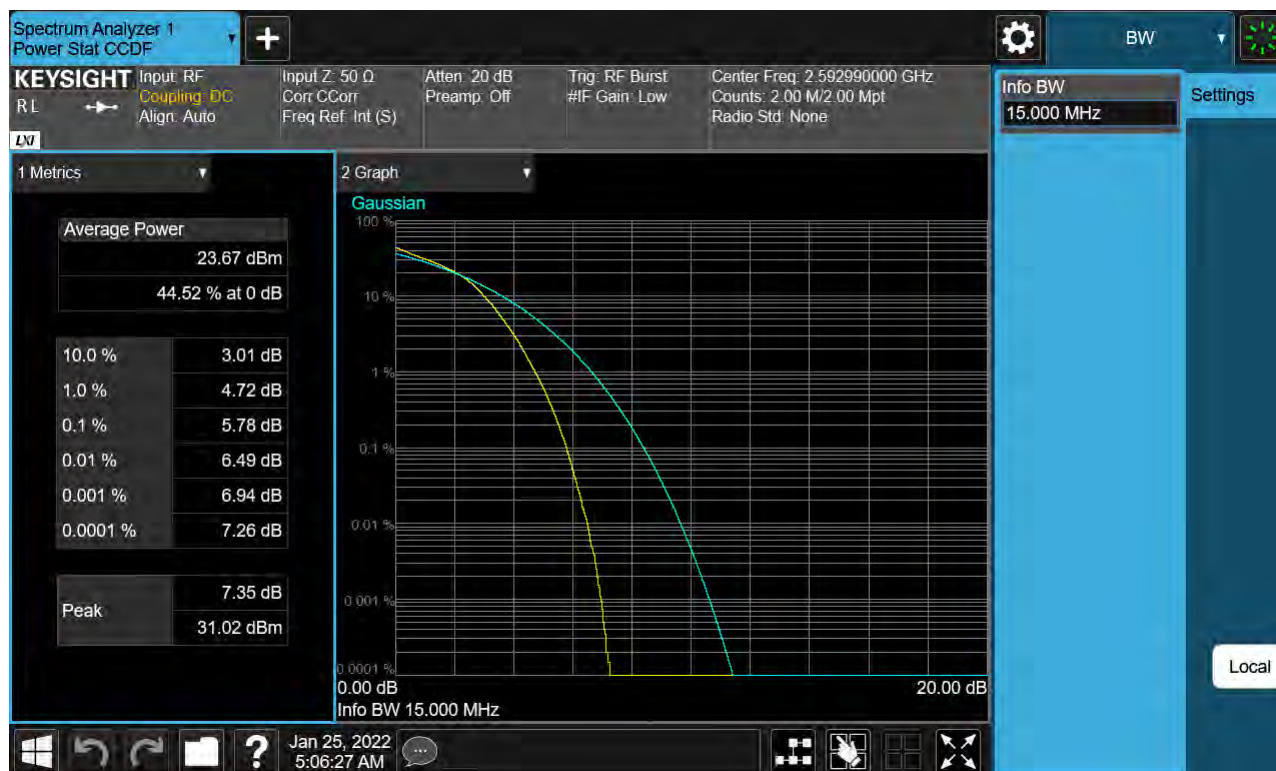
Sub6 n41. PAR Plot (15 M BW_Ch.518598_16QAM)
