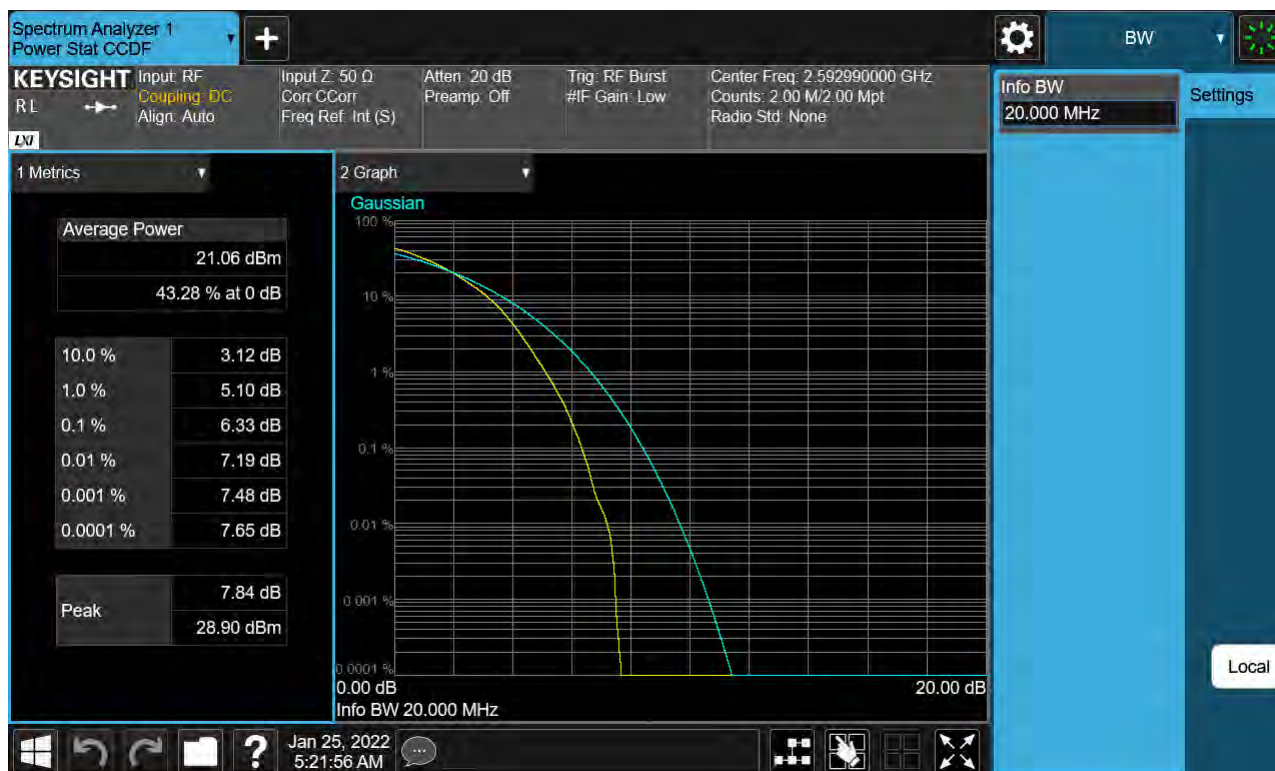
Sub6 n41. PAR Plot (20 M BW_Ch.518598_256QAM)
