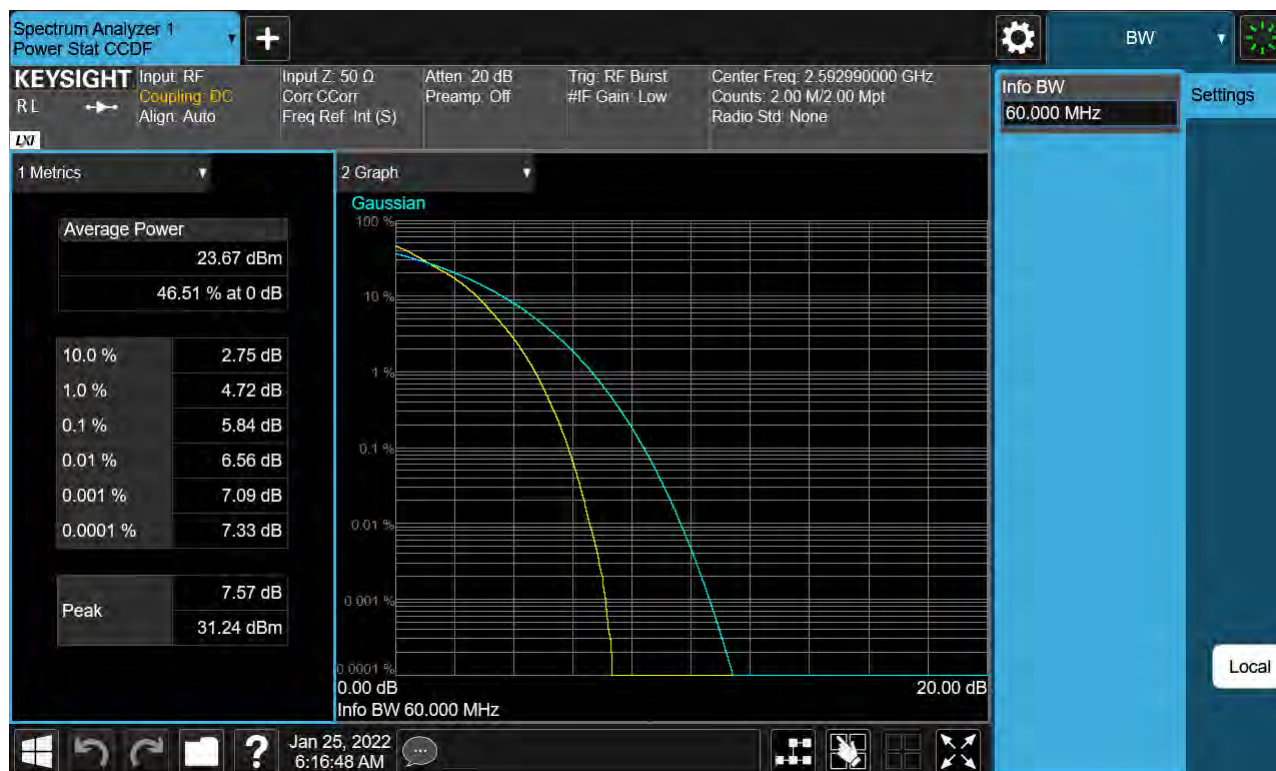
Sub6 n41. PAR Plot (60 M BW_Ch.518598_16QAM)
