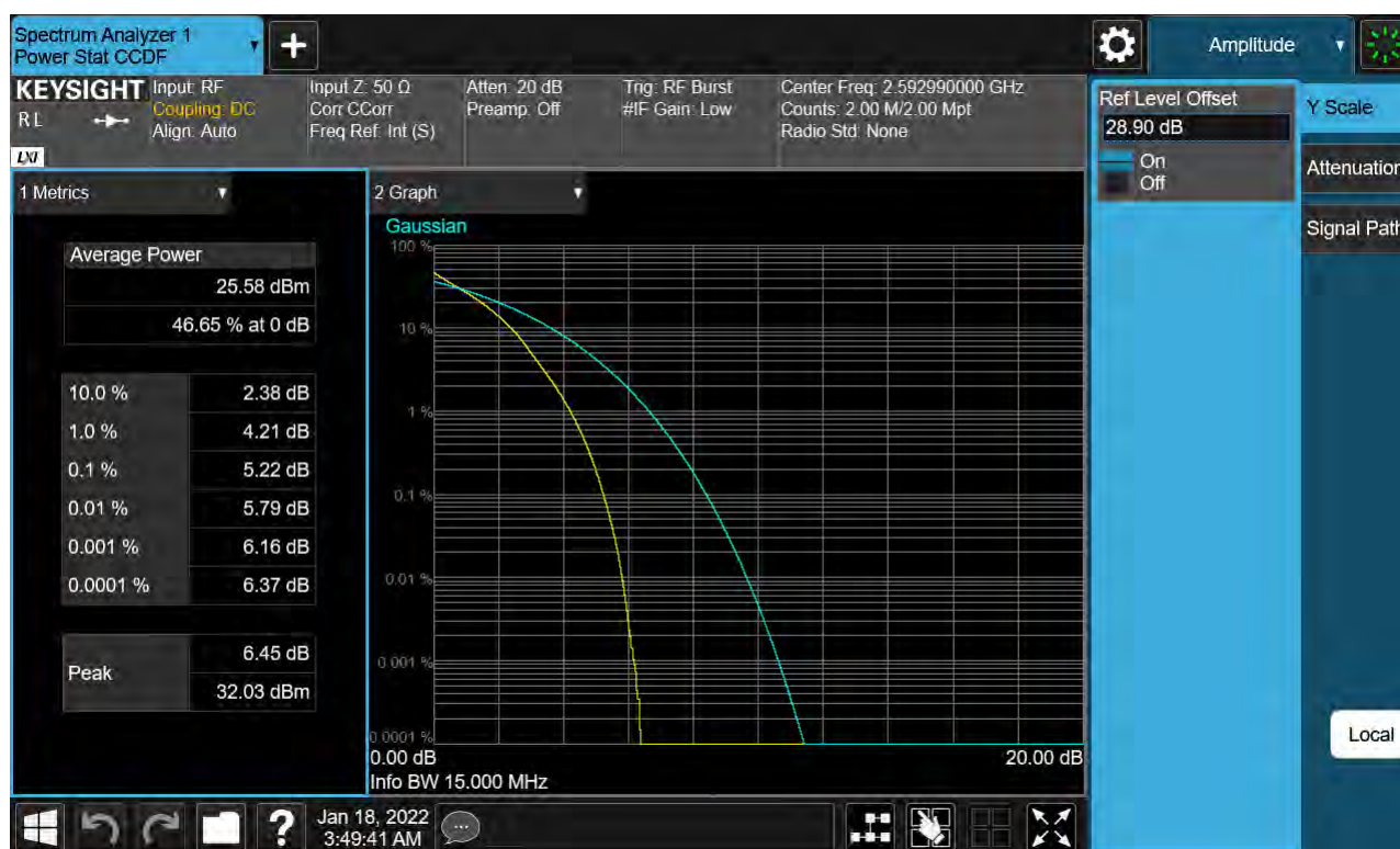
Sub6 n41. PAR Plot (15 M BW_Ch.518598_QPSK)
