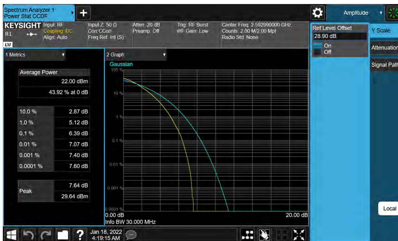
Sub6 n41. PAR Plot (30 M BW_Ch.518598_256QAM)
