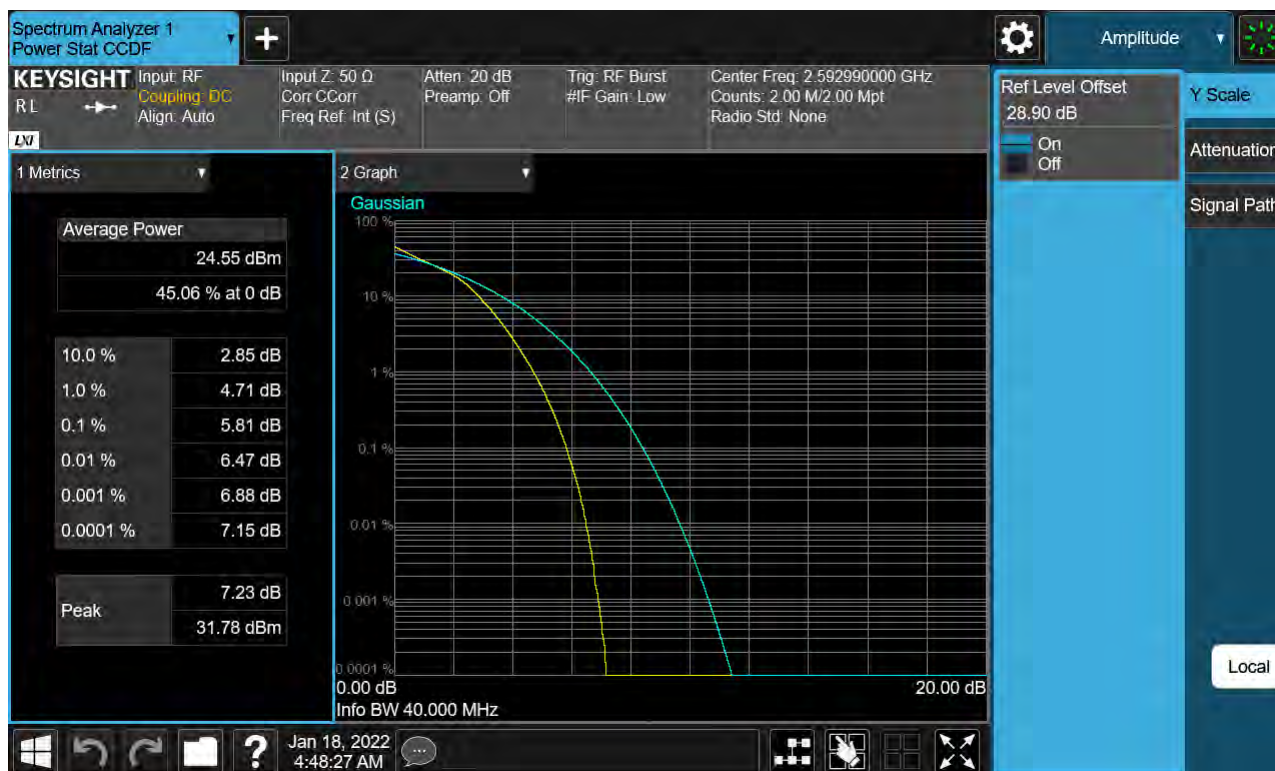
Sub6 n41. PAR Plot (40 M BW_Ch.518598_16QAM)
