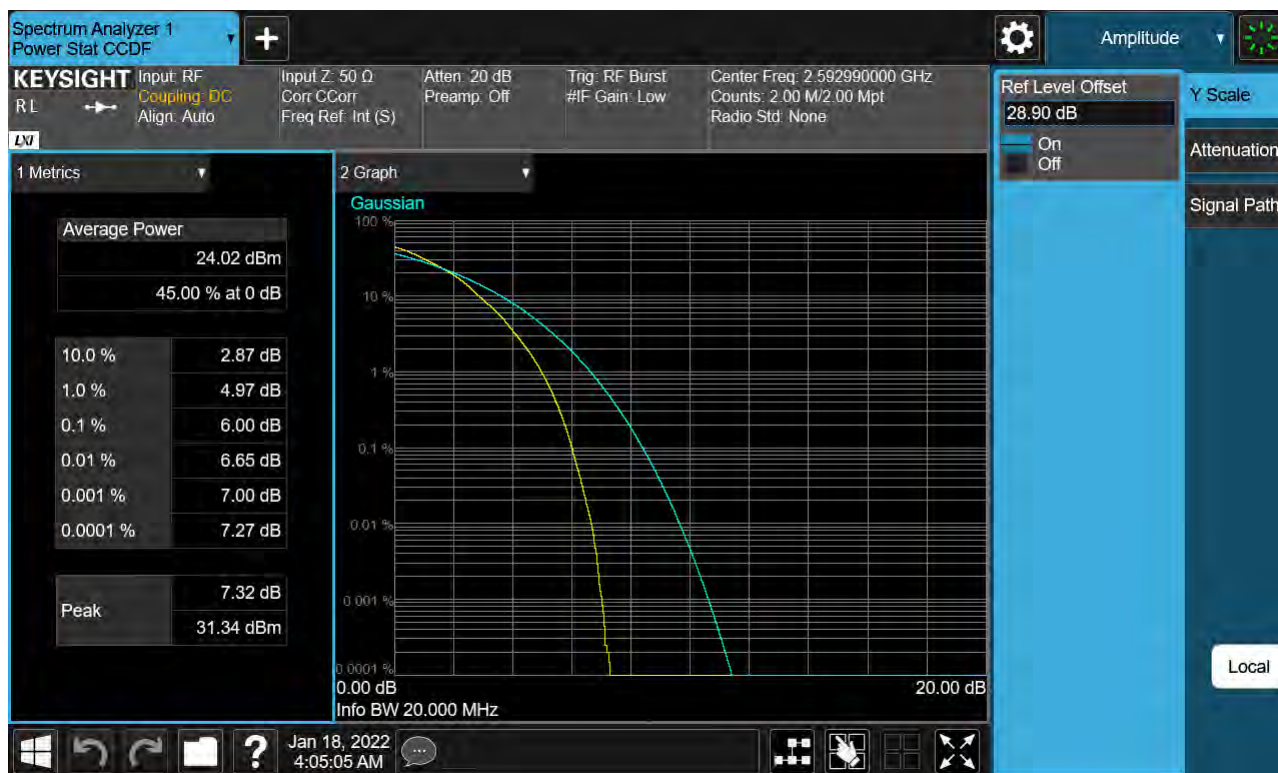
Sub6 n41. PAR Plot (20 M BW_Ch.518598_64QAM)
