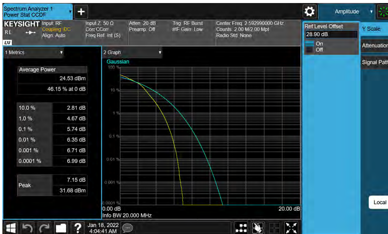
Sub6 n41. PAR Plot (20 M BW_Ch.518598_16QAM)
