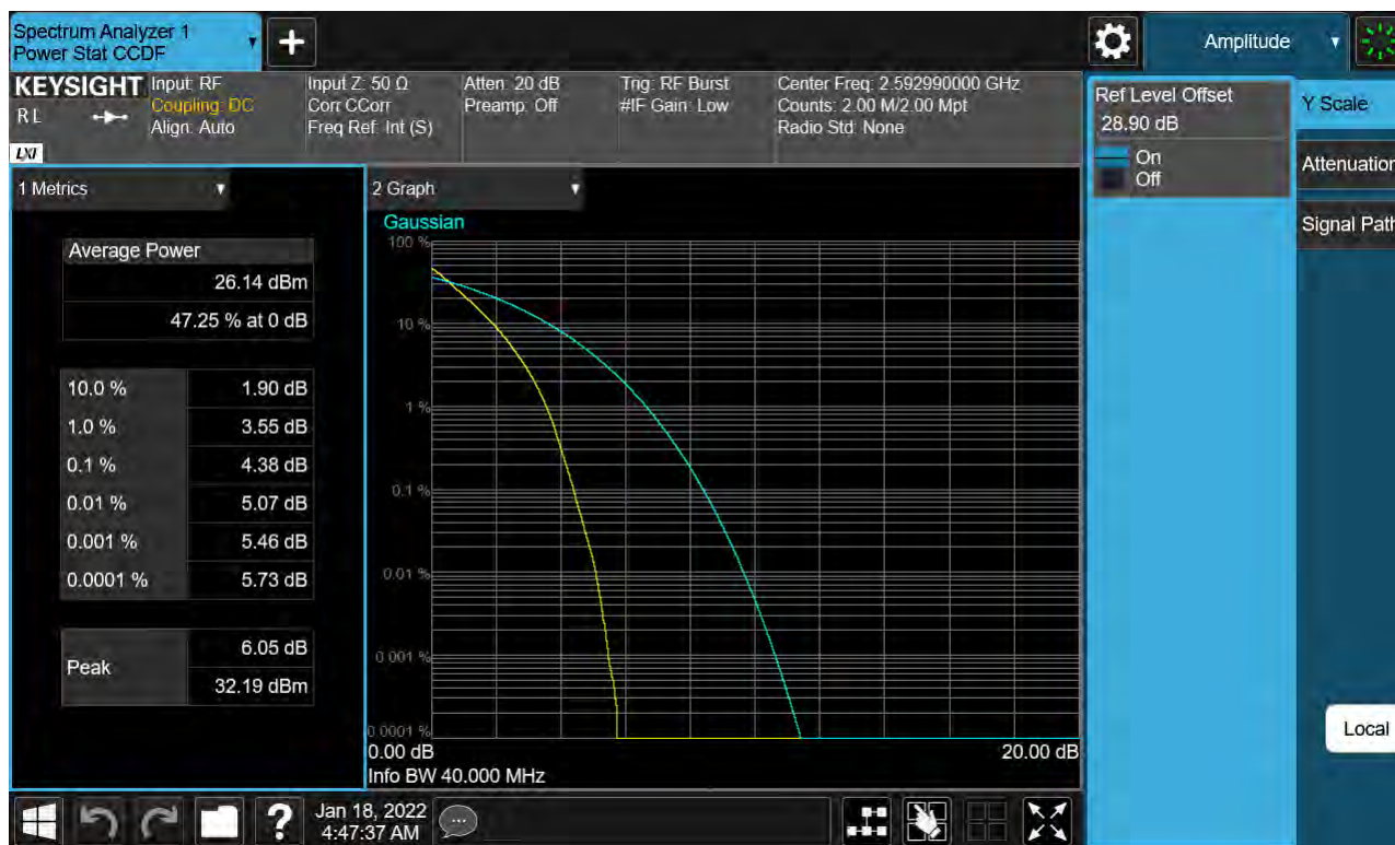
Sub6 n41. PAR Plot (40 M BW_Ch.518598_BPSK)
