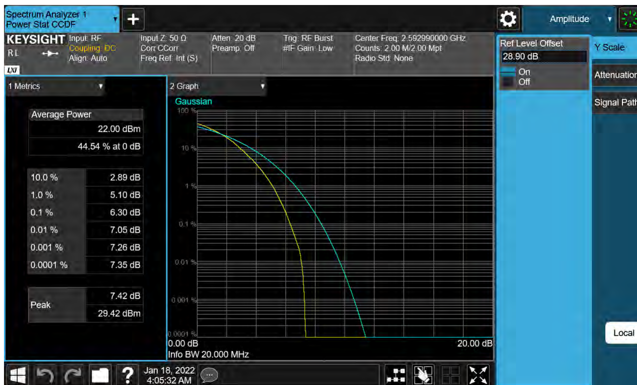
Sub6 n41. PAR Plot (20 M BW_Ch.518598_256QAM)
