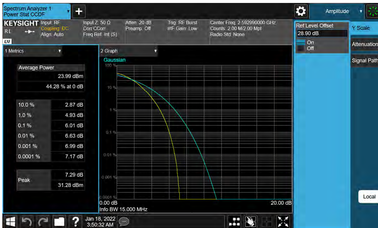
Sub6 n41. PAR Plot (15 M BW_Ch.518598_64QAM)
