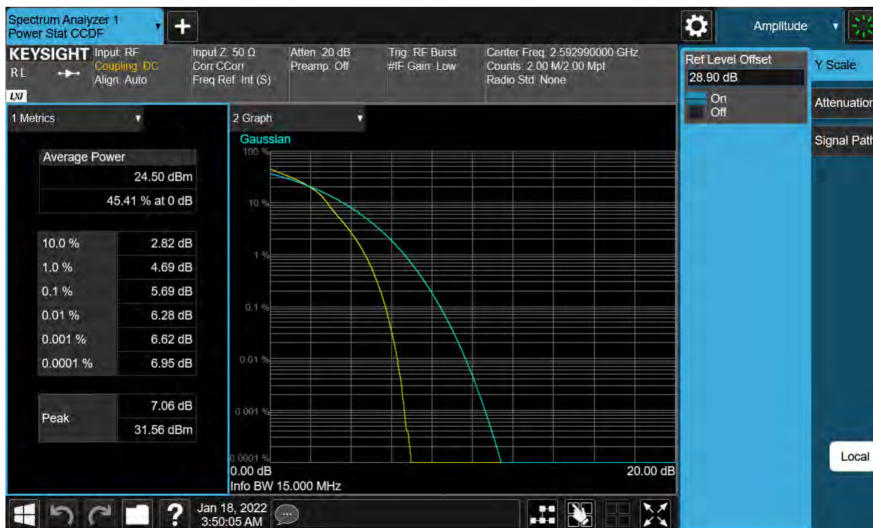
Sub6 n41. PAR Plot (15 M BW_Ch.518598_16QAM)
