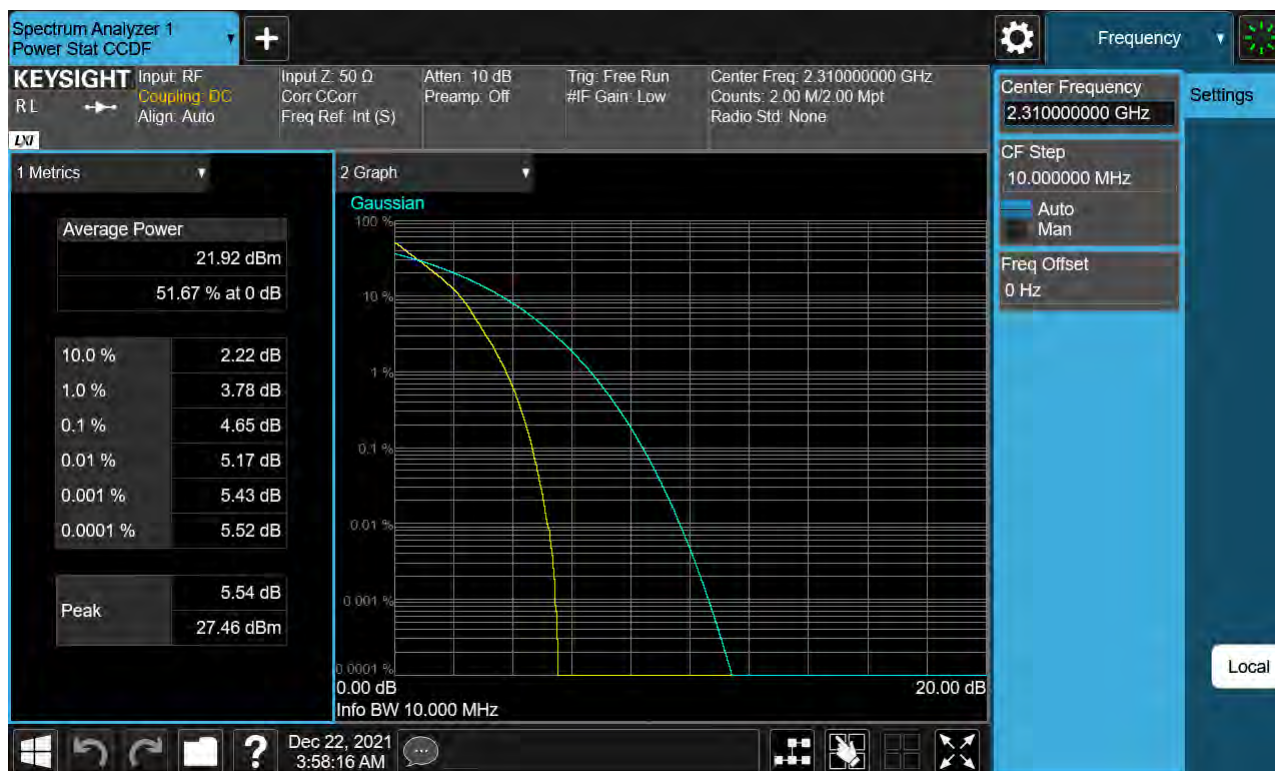
Sub6 n30. PAR Plot (10M BW_Ch.462000_QPSK_RB50_0)
