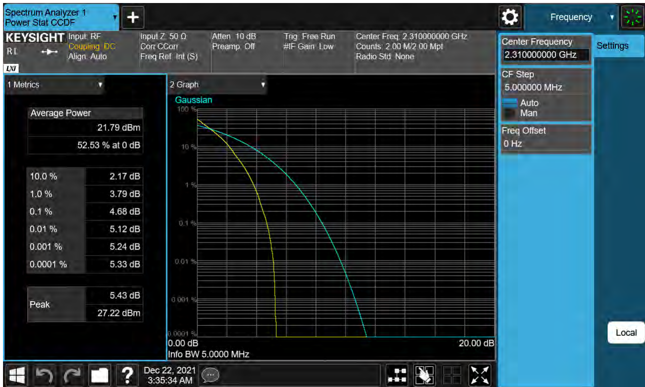
Sub6 n30. PAR Plot (5M BW_Ch.462000_QPSK_RB25_0)
