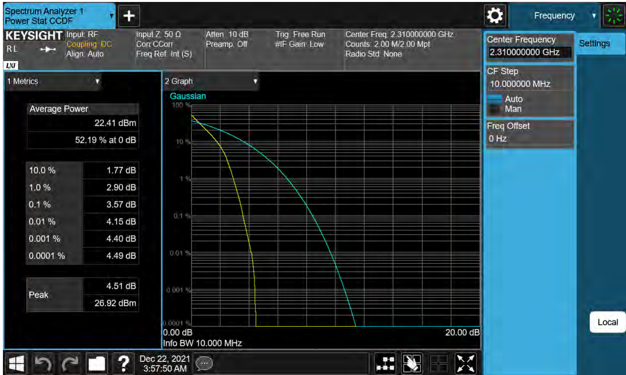
Sub6 n30. PAR Plot (10M BW_Ch.462000_BPSK_RB50_0)
