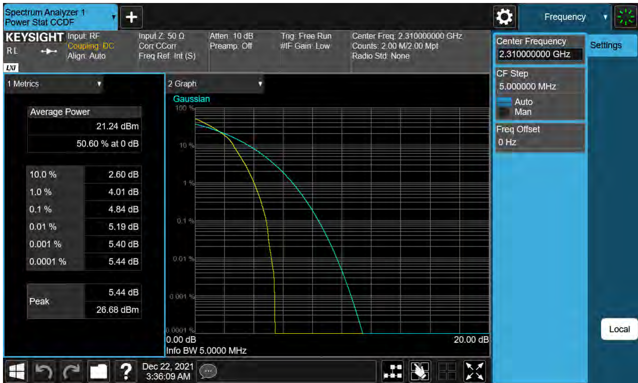
Sub6 n30. PAR Plot (5M BW_Ch.462000_16QAM_RB25_0)
