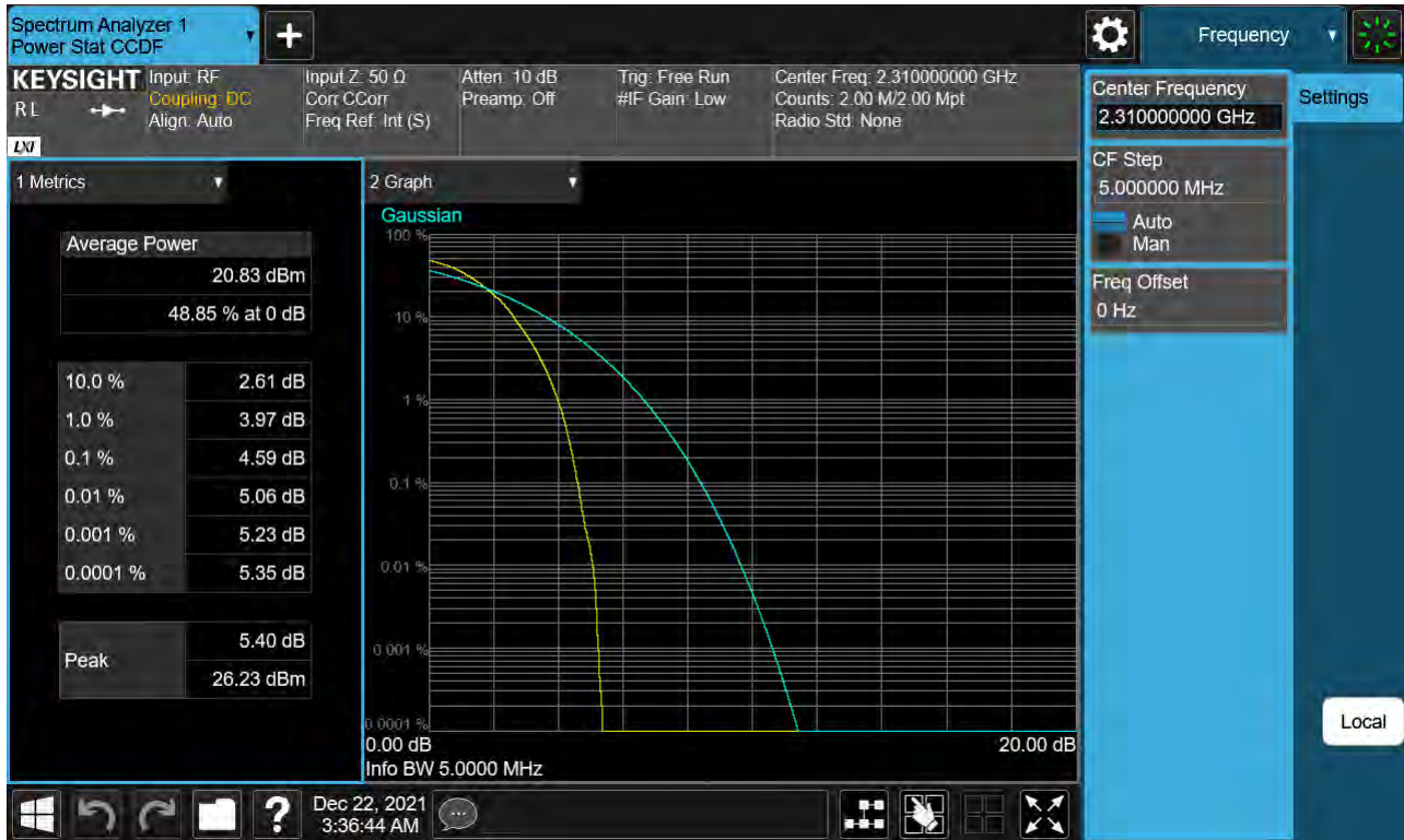
Sub6 n30. PAR Plot (5M BW_Ch.462000_64QAM_RB25_0)
