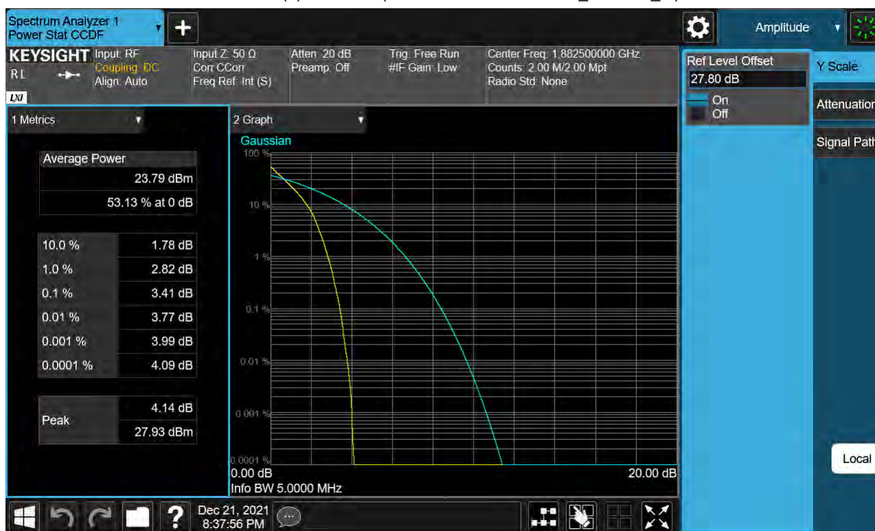
Sub6 n25(2). PAR Plot (5 M BW Ch.376500 BPSK_ Full RB _0 )
