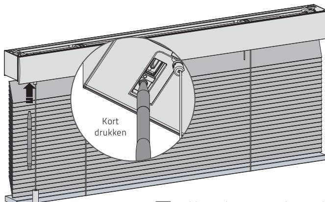
12.1 Druk kort op de programmeerknop om de programmeermodus uit te schakelen. De jaloezie stopt met draaien en kan worden bediend.
