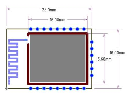
模块尺寸 23\*16\*3. 2mm(长\*宽\*高) 公差: ±0. 1mm Module Size: 23\*16\*3.2mm (L\*W\*H) tolerance: ±0.1mm
