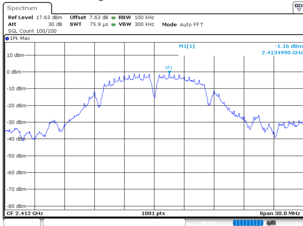
Band Edge NVNT 802.11b 2412MHz Ant1 Ref
