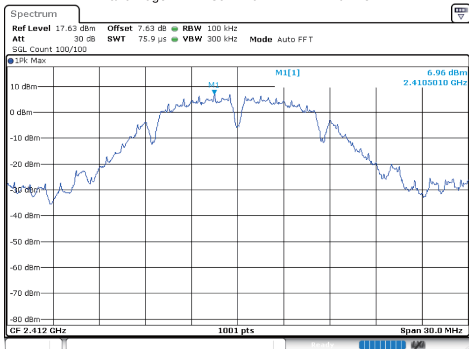
Band Edge NVNT 802.11b 2412MHz Ant1 Ref
