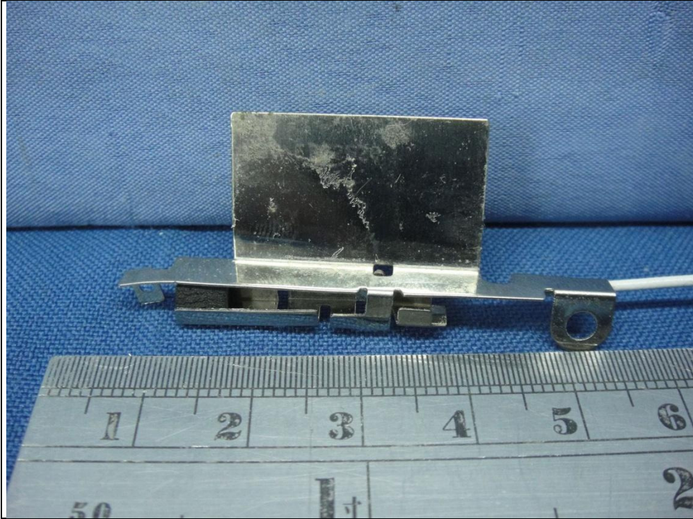
Antenna set 1 (Chain 1 / Brand : WNC, Model : 81-EBJ15.005)
