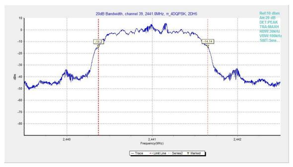
Fig.86. 20dB Bandwidth:  $\pi/4$  DQPSK, Channel 39
