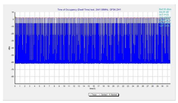
Fig.65. Number of Transmissions Measurement: Channel 39, Packet DH1
