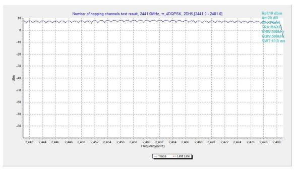
Fig.97. Number of hopping frequencies:  $\pi/4$  DQPSK, Channel 40 - 78
