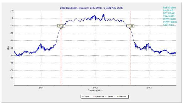
Fig.85. 20dB Bandwidth: π/4 DQPSK, Channel 0
