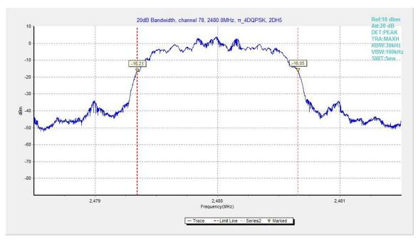
Fig.87. 20dB Bandwidth: π/4 DQPSK, Channel 78
