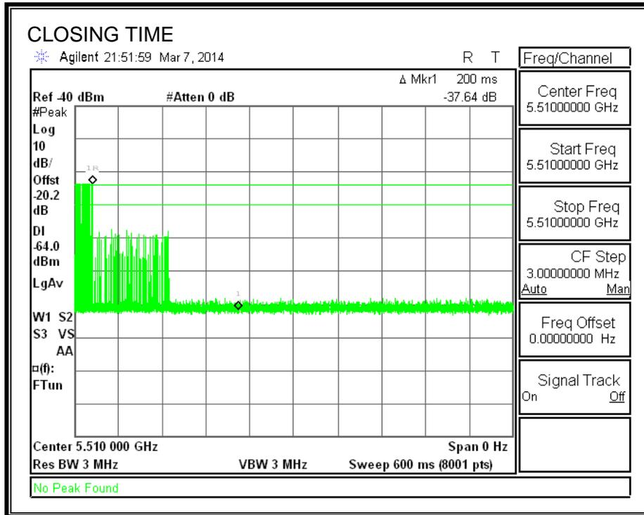
**AGGREGATE CHANNEL CLOSING TRANSMISSION TIME**
