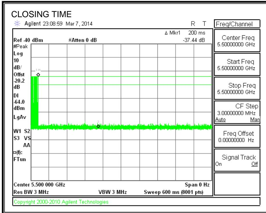
**AGGREGATE CHANNEL CLOSING TRANSMISSION TIME**
