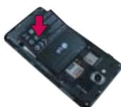
**2** Alinee los contactos de la batería con los terminales en el compartimiento de la batería y empuje la batería hacia abajo hasta que encaje en su lugar.
