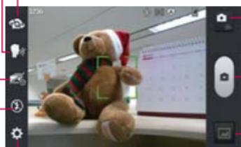
**Alternar Modo** – Permite alternar entre modo de cámara y modo de video.
