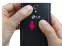
**3** Coloque la tapa posterior sobre el compartimiento de la batería y luego presione la tapa hacia abajo hasta que encaje en su lugar.
