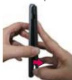
**1** Use la abertura de dedos en la parte inferior del teléfono para extraer la tapa de la tapa posterior.
