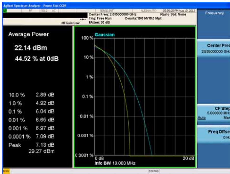
PAR Plot (10MHz 16-QAM - RB Size 50)
