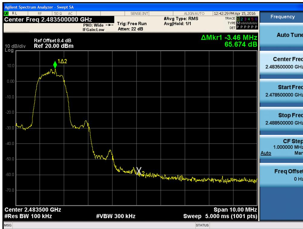
Test Plots without hopping ( $\pi/4$ DQPSK)
