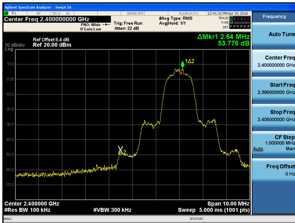
Test Plots without hopping ( $\pi/4$ DQPSK)
