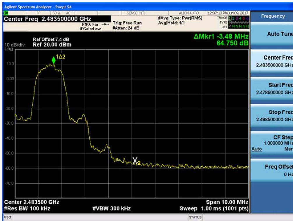
Test Plots without hopping ( $\pi/4$ DQPSK)
