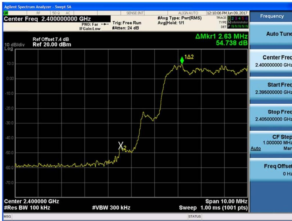
Test Plots with hopping ( $\pi/4$ DQPSK)
