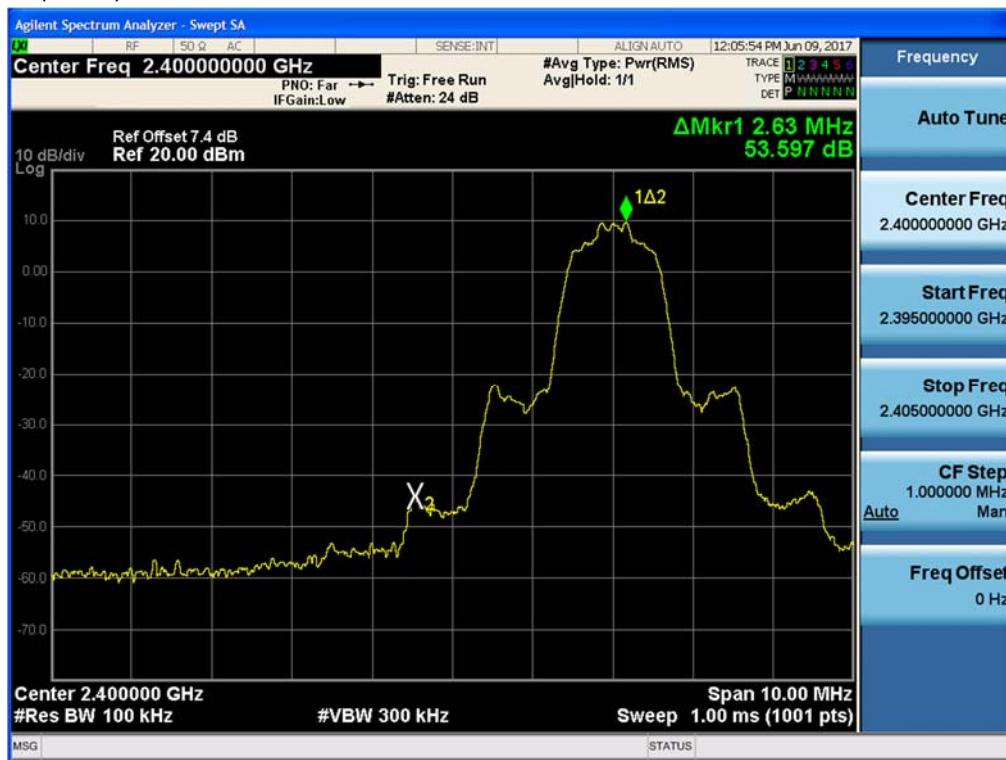
Test Plots without hopping ( $\pi/4$ DQPSK)
