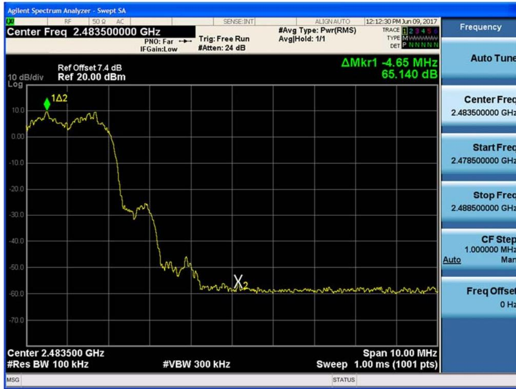
Test Plots with hopping ( $\pi/4$ DQPSK)
