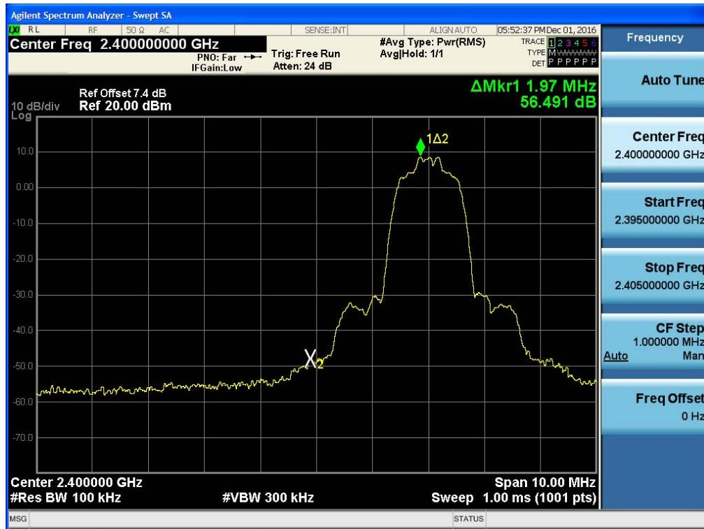
Test Plots without hopping ( $\pi/4$ DQPSK)
