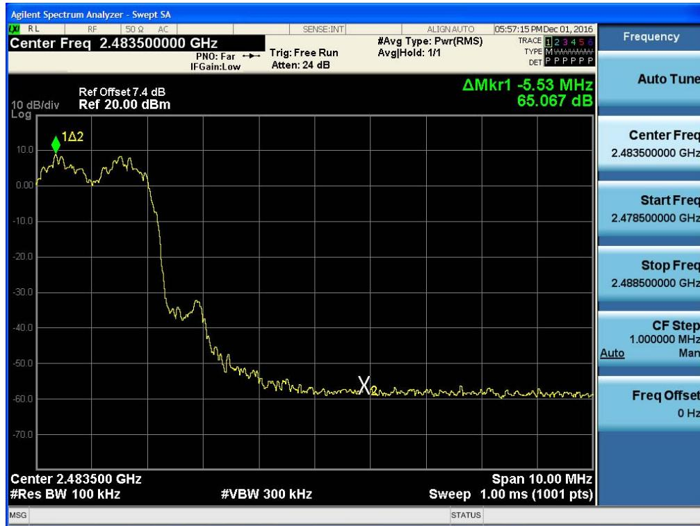
Test Plots with hopping ( $\pi/4$ DQPSK)
