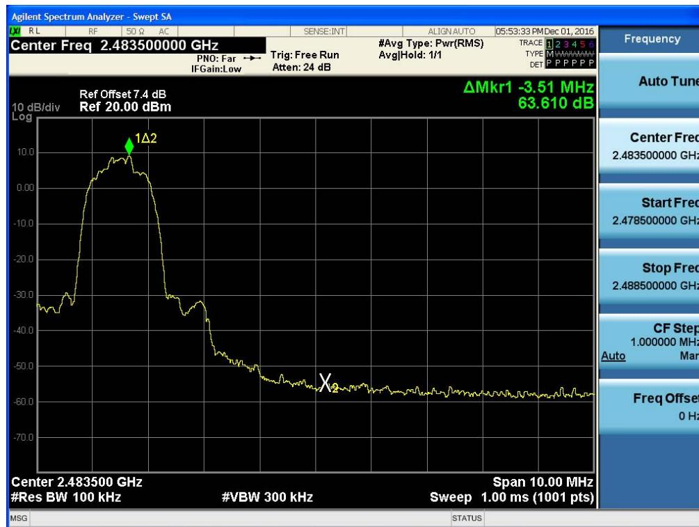
Test Plots without hopping ( $\pi/4$ DQPSK)
