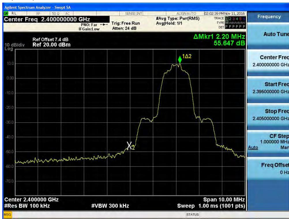
Test Plots without hopping ( $\pi/4$ DQPSK)
