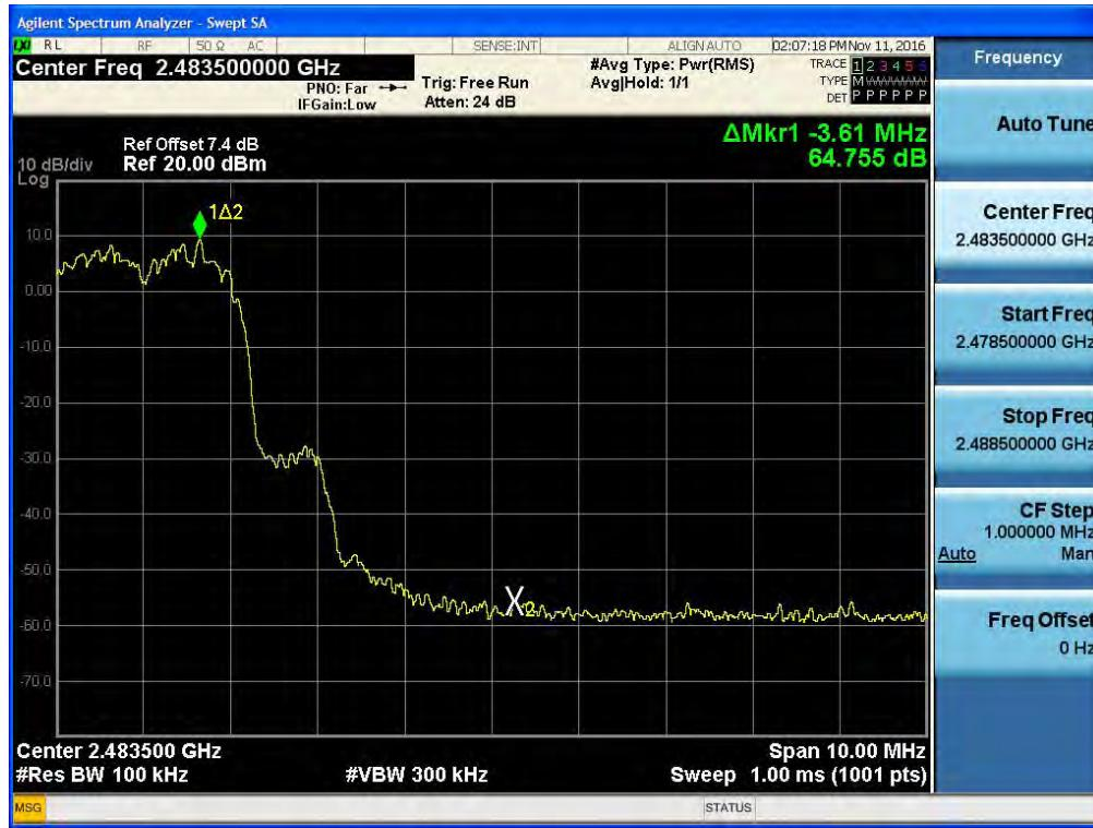
Test Plots with hopping ( $\pi/4$ DQPSK)
