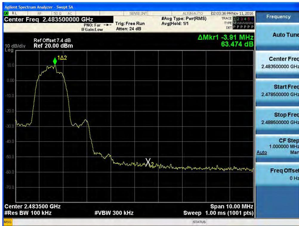
Test Plots without hopping ( $\pi/4$ DQPSK)
