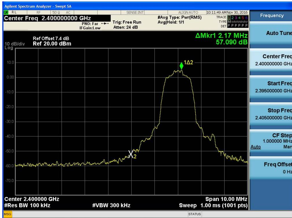
Test Plots without hopping ( $\pi/4$ DQPSK)
