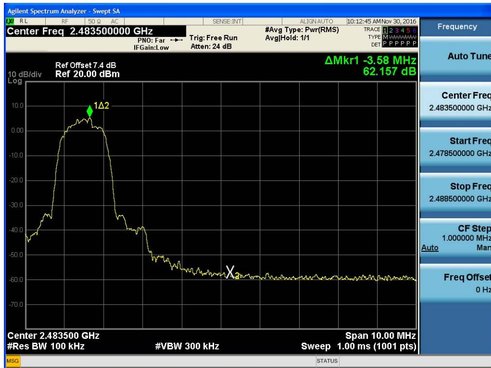
Test Plots without hopping ( $\pi/4$ DQPSK)
