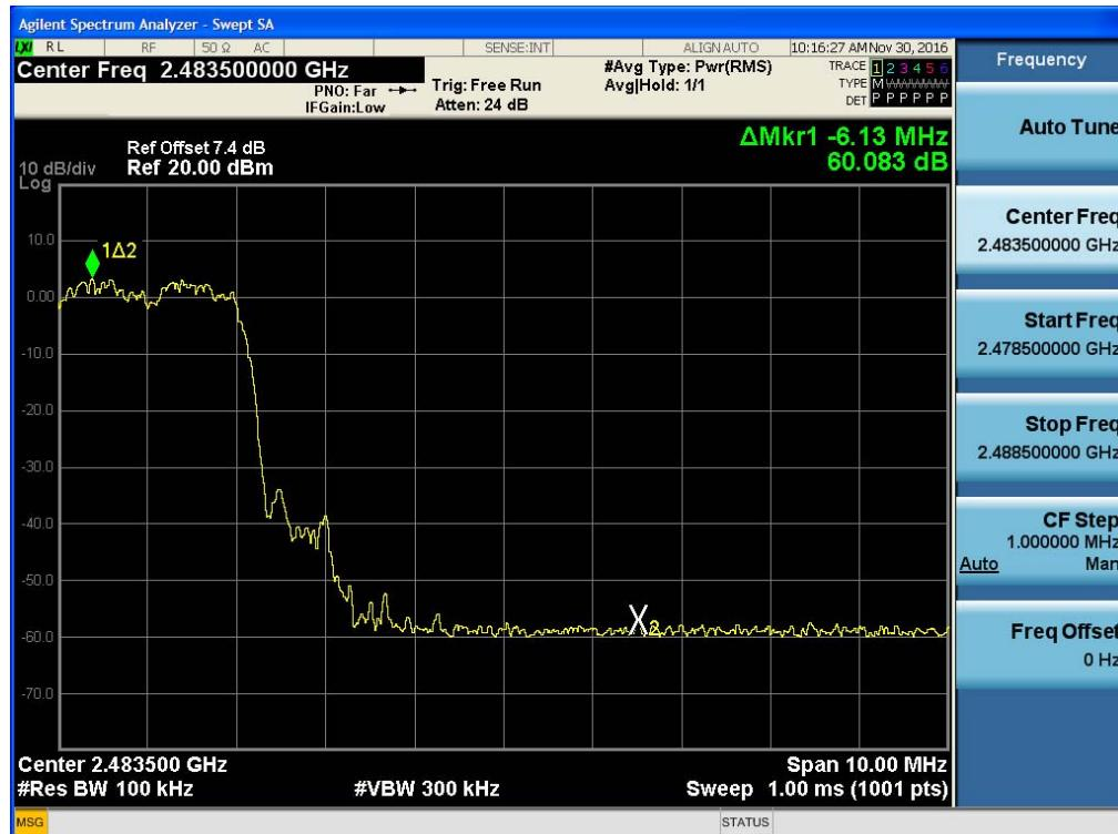
Test Plots with hopping ( $\pi/4$ DQPSK)
