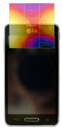
Figure 18-4 E-Field WD Scan overlay
