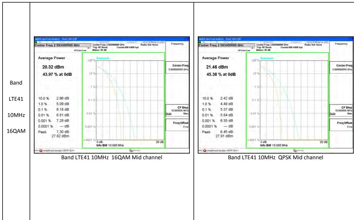
Band LTE41 10MHz 16QAM Mid channel
