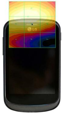
Figure 18-4 E-Field WD Scan overlay
