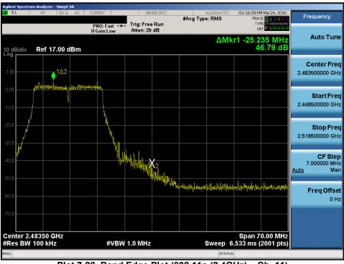
Plot 7-28. Band Edge Plot (802.11n (2.4GHz) - Ch. 11)
