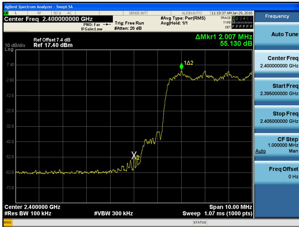
Test Plots with hopping ( $\pi/4$ DQPSK)
