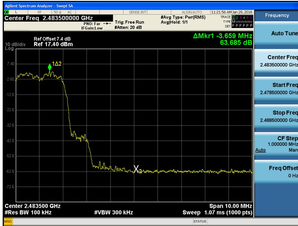
Test Plots with hopping ( $\pi/4$ DQPSK)
