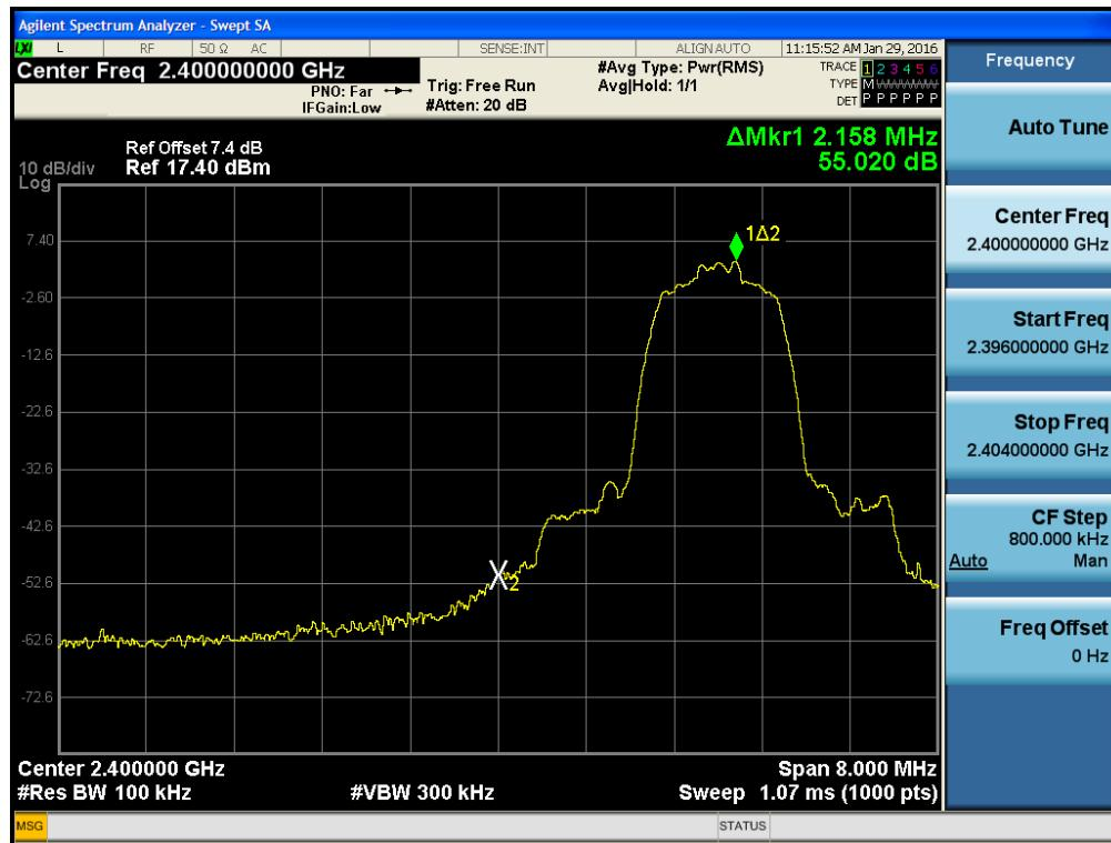
Test Plots without hopping ( $\pi/4$ DQPSK)
