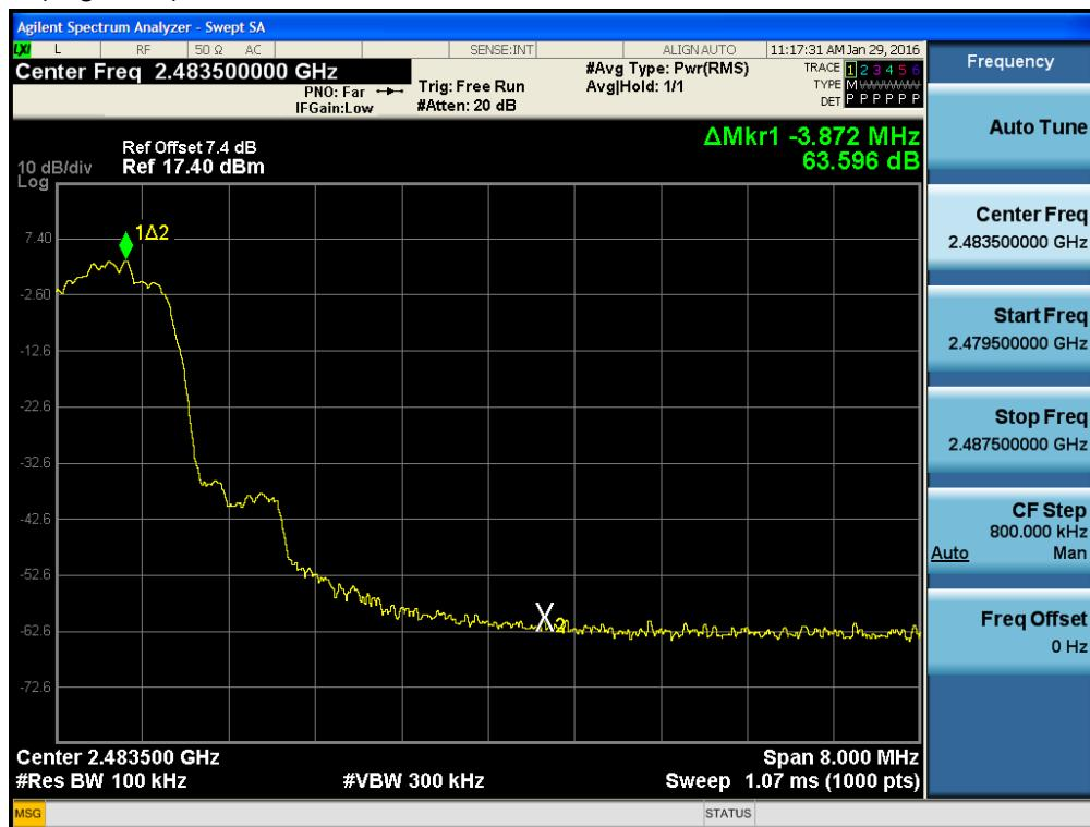
Test Plots without hopping ( $\pi/4$ DQPSK)
