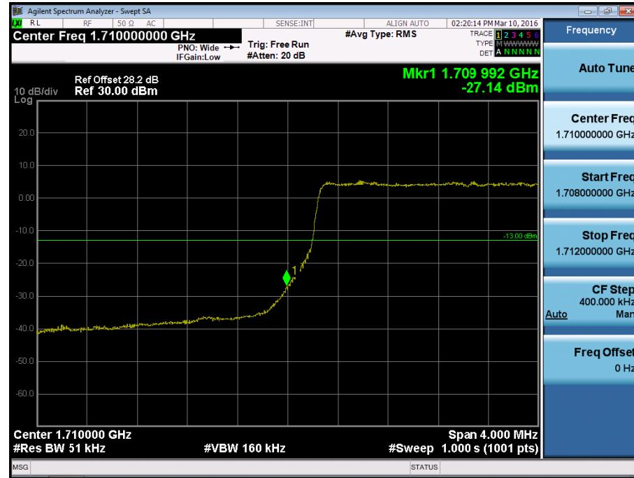
BAND 4. Lower Extended Band Edge Plot (5M BW Ch.19975 QPSK\_RB25\_0) -3
