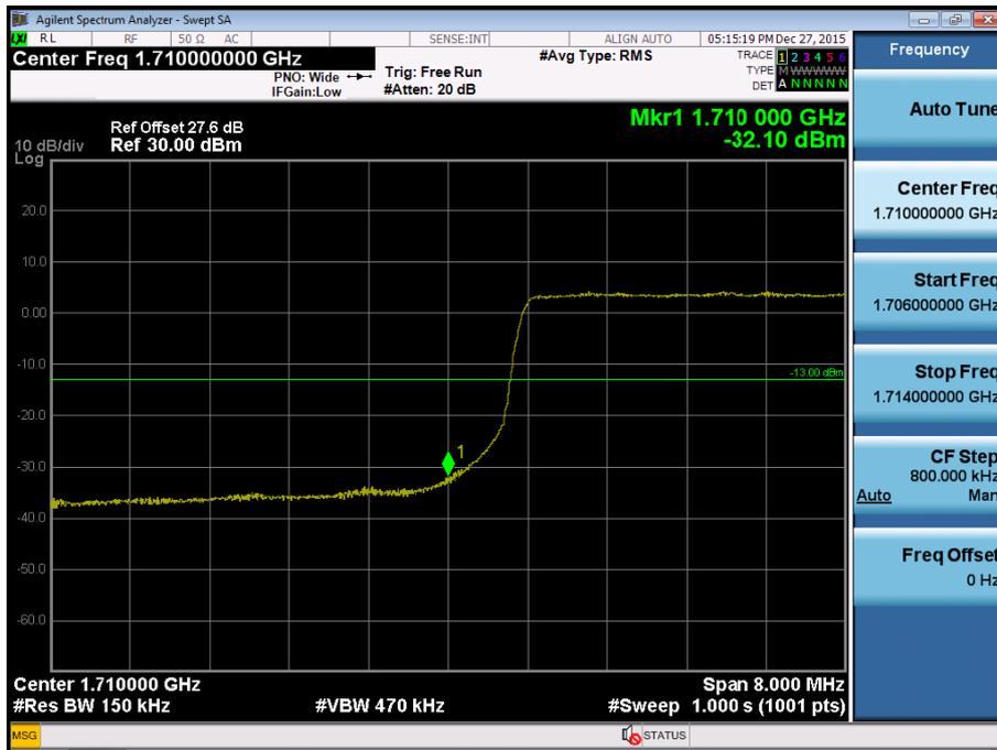
BAND 4. Lower Extended Band Edge Plot (15M BW Ch.20025 QPSK\_RB75\_0) -3
