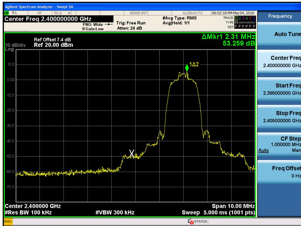
Test Plots without hopping ( $\pi/4$ DQPSK)
