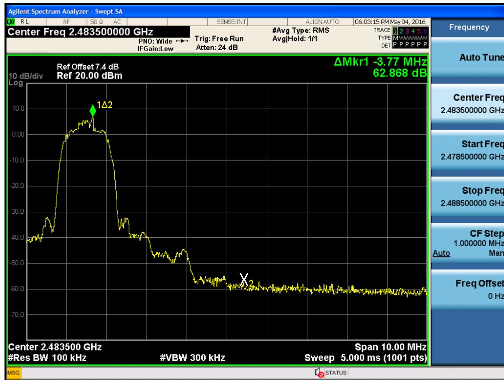
Test Plots without hopping ( $\pi/4$ DQPSK)
