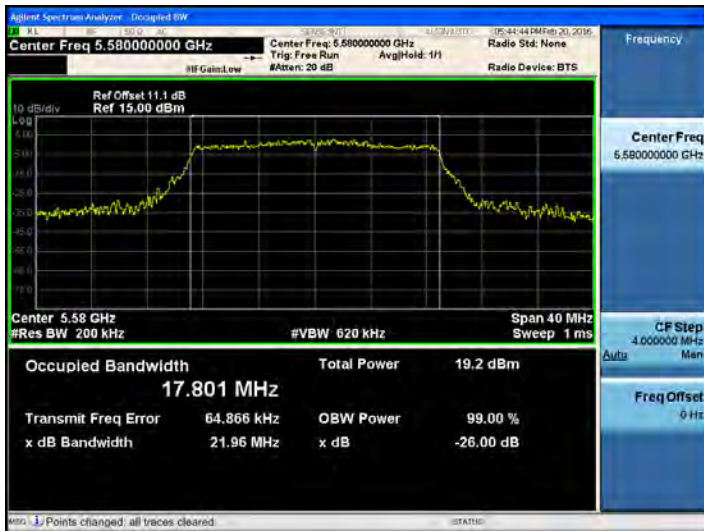
802.11ac_20 MHz BW UNII 2C BAND 26dB Bandwidth(CH 116)
