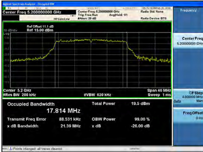
802.11ac_20 MHz BW UNII 2C BAND 26dB Bandwidth(CH 116)
