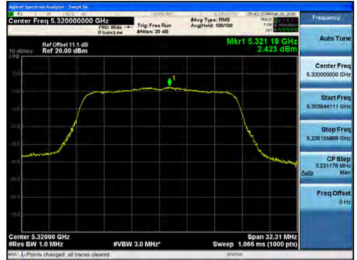
802.11ac_20MHz BW UNII 3 BAND PSD CH 165
