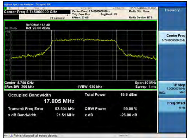
802.11ac_20 MHz BW UNII 3 BAND 26dB Bandwidth(CH 149)
