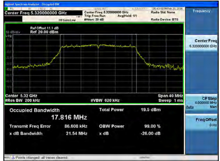
802.11ac_20 MHz BW UNII 3 BAND 26dB Bandwidth(CH 149)
