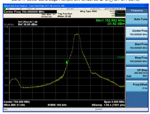
Band 17 Lower Band Edge Plot (5M BW Ch.23755 QPSK\_RB25)
