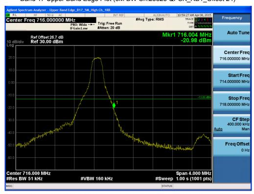
Band 17 Upper Band Edge Plot (5M BW Ch.23825 QPSK\_RB25)
