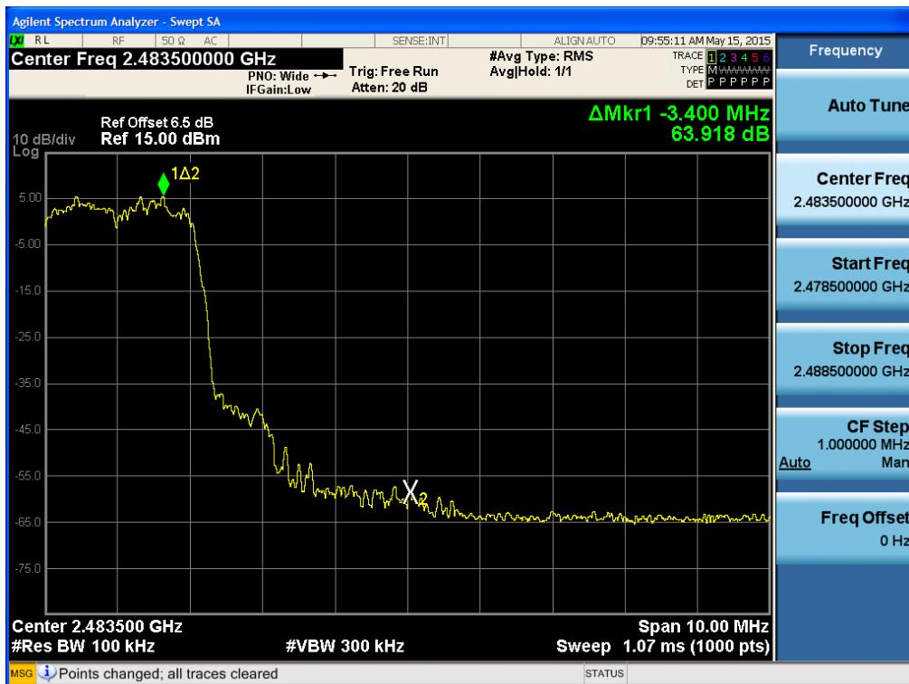
Test Plots with hopping ( $\pi/4$ DQPSK)
