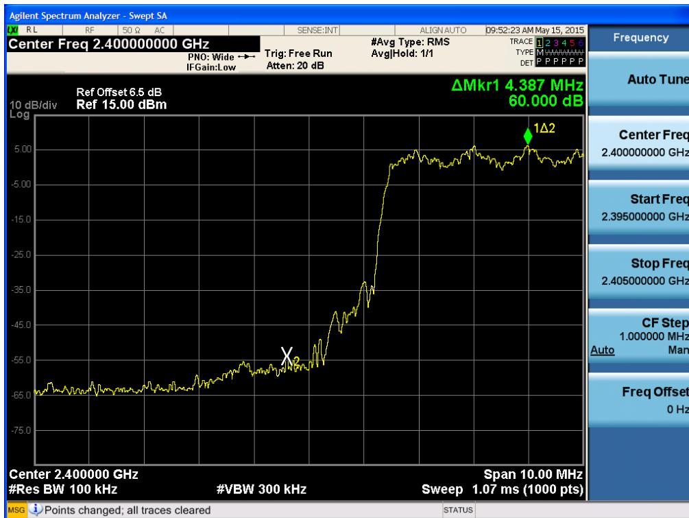
Test Plots with hopping ( $\pi/4$ DQPSK)
