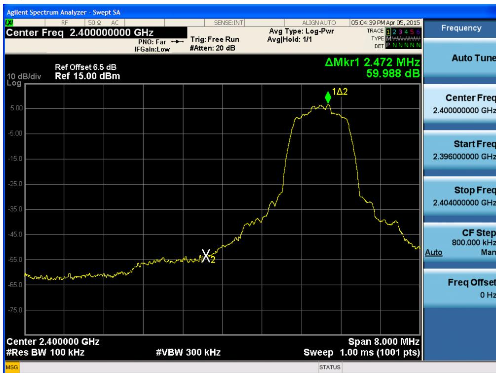
Test Plots without hopping ( $\pi/4$ DQPSK)
