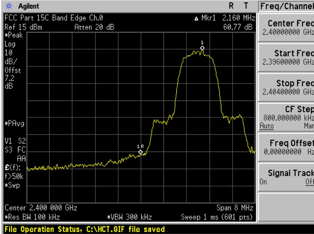
Test Plots without hopping ( $\pi/4$ DQPSK)
