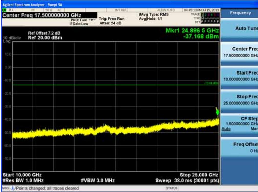
Test Plots ( $\pi/4$ DQPSK) - 10 GHz - 25 GHz (RBW:1 MHz, VBW: 3 MHz)
