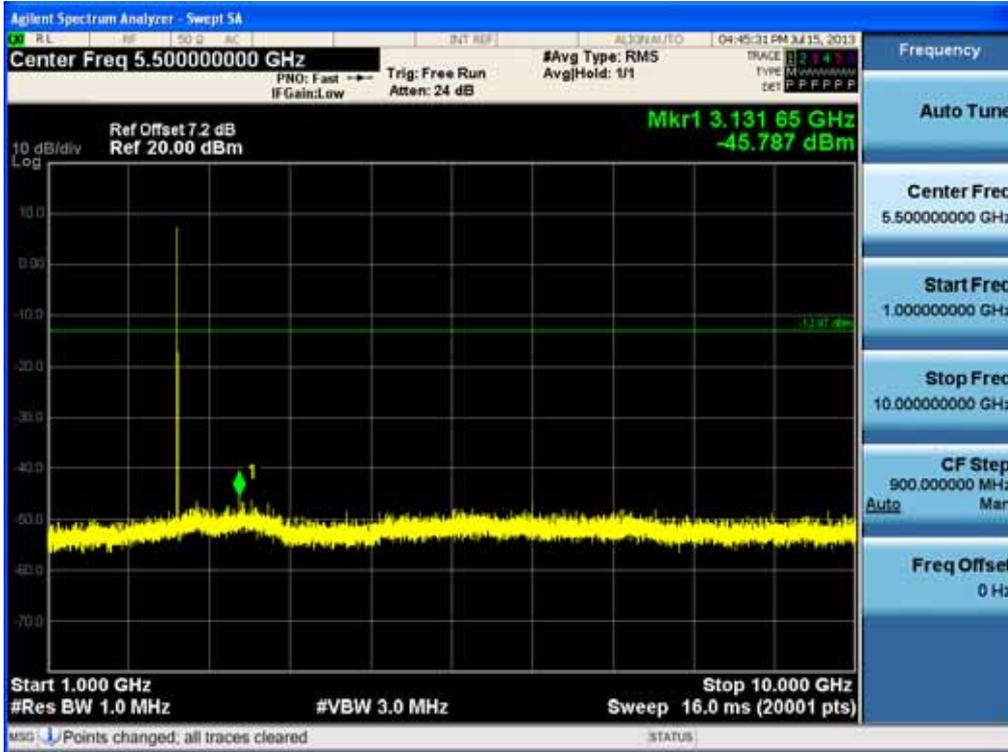
Test Plots ( $\pi/4$ DQPSK) - 1 GHz - 10 GHz (RBW:1 MHz, VBW: 3 MHz)
