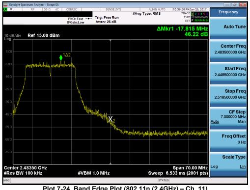
Plot 7-24. Band Edge Plot (802.11n (2.4GHz) - Ch. 11)
