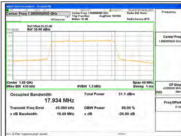
B2 / 20MHz / QPSK/ Mid CH
