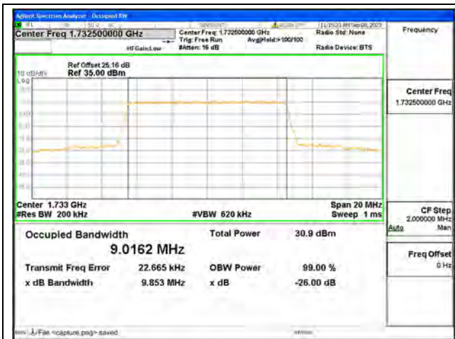
B4 / 10MHz / QPSK/ Mid CH
