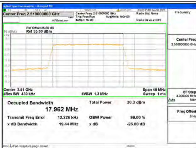
B7 / 20MHz / 16QAM/ Low CH
