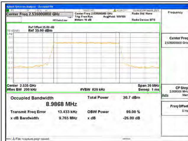
B7 / 10MHz / QPSK/ Mid CH
