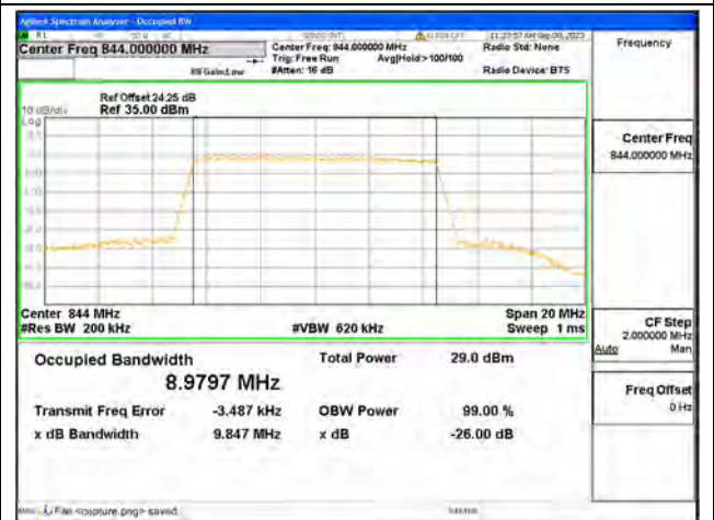
B5 / 10MHz / 64QAM/ High CH
