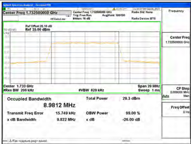
B4 / 10MHz / 64QAM/ Mid CH
