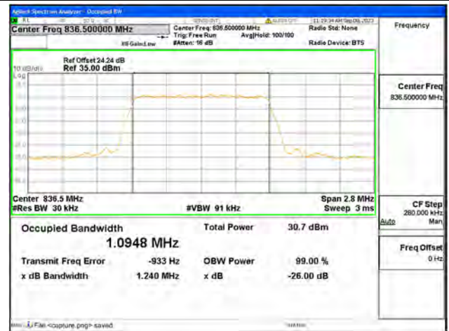
B5 / 1.4MHz / QPSK/ Mid CH
