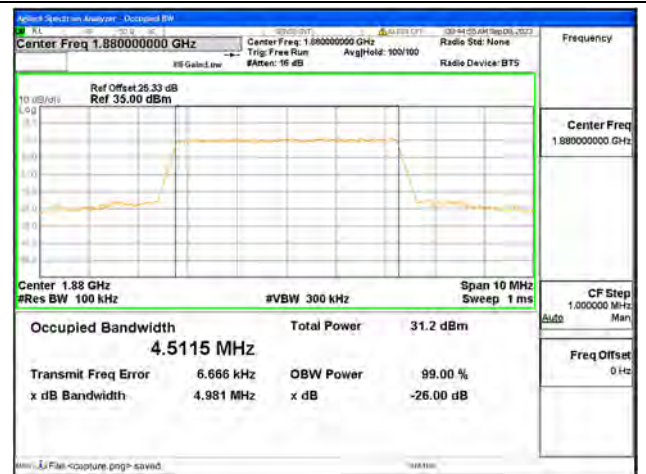
B2 / 5MHz / QPSK/ Mid CH
