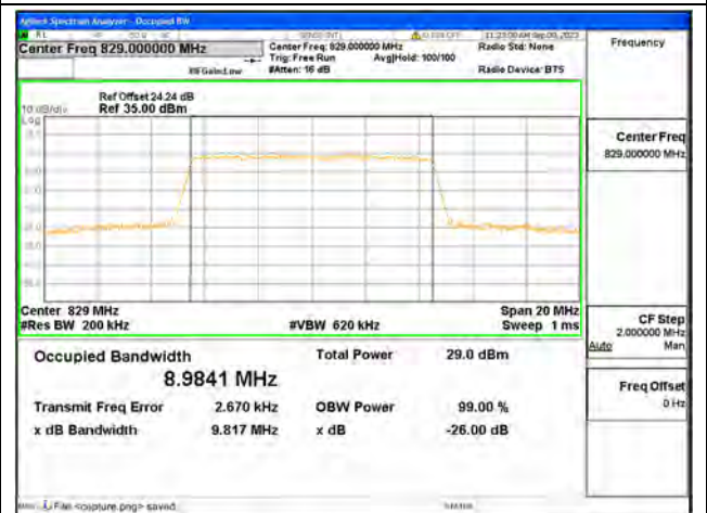
B5 / 10MHz / 64QAM/ Low CH
