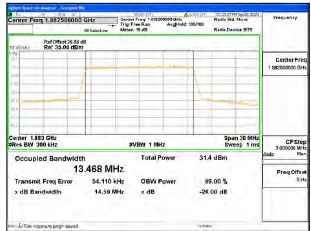
B25 / 15MHz / QPSK/ Mid CH
