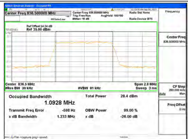
B5 / 1.4MHz / 64QAM/ Mid CH
