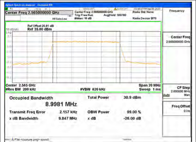
B7 / 10MHz / QPSK/ High CH
