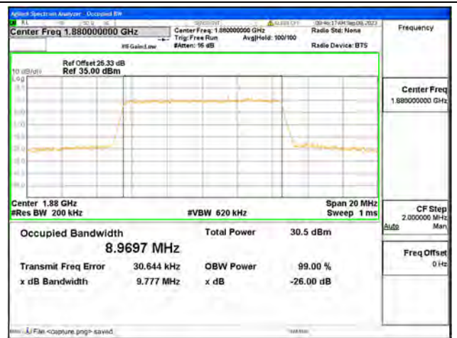
B2 / 10MHz / 16QAM/ Mid CH
