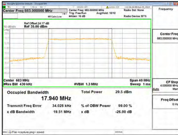
Band71 / 20MHz / 64QAM/ Mid CH
