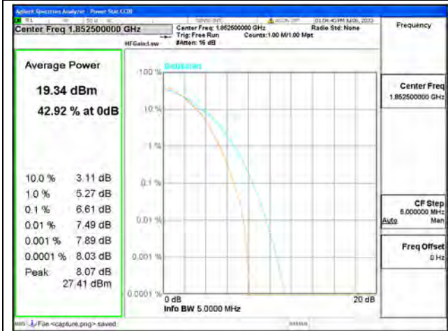
Band25 / 5MHz / Low CH / 64QAM
