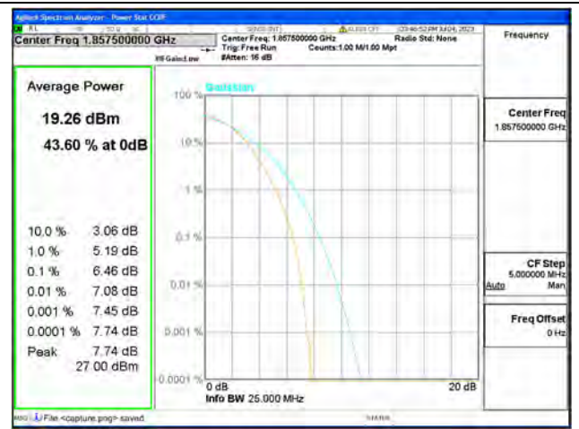
Band2 / 15MHz / Low CH / 16QAM
