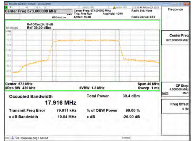
Band71 / 20MHz / QPSK/ Low CH
