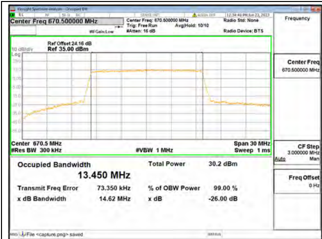
Band71 / 15MHz / QPSK/ Low CH
