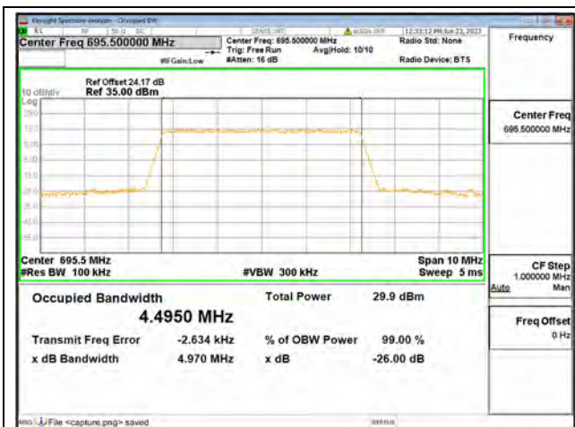
Band71 / 5MHz / QPSK/ High CH
