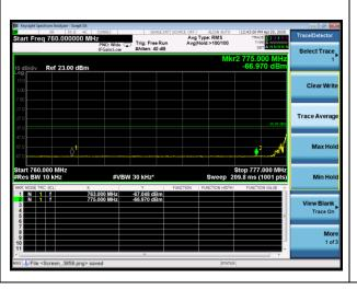
NB-IOT Band 13 QPSK 15kHz 12@0 (793MHz ~805MHz)
