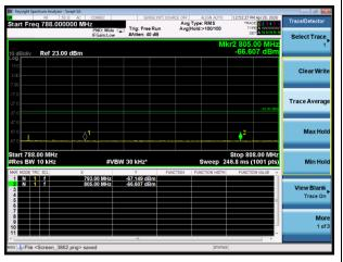
NB-IOT Band 13 QPSK 15kHz 12@0 (763MHz ~775MHz)
