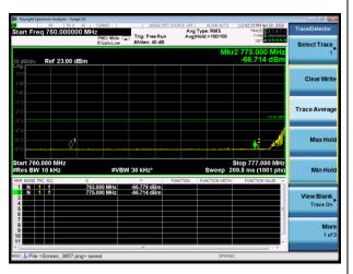
NB-IOT Band 13 QPSK 15kHz (793MHz ~805MHz)
