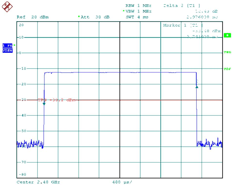
Modulation Standard:  $\pi/4$ -DQPSK (2Mbps)
