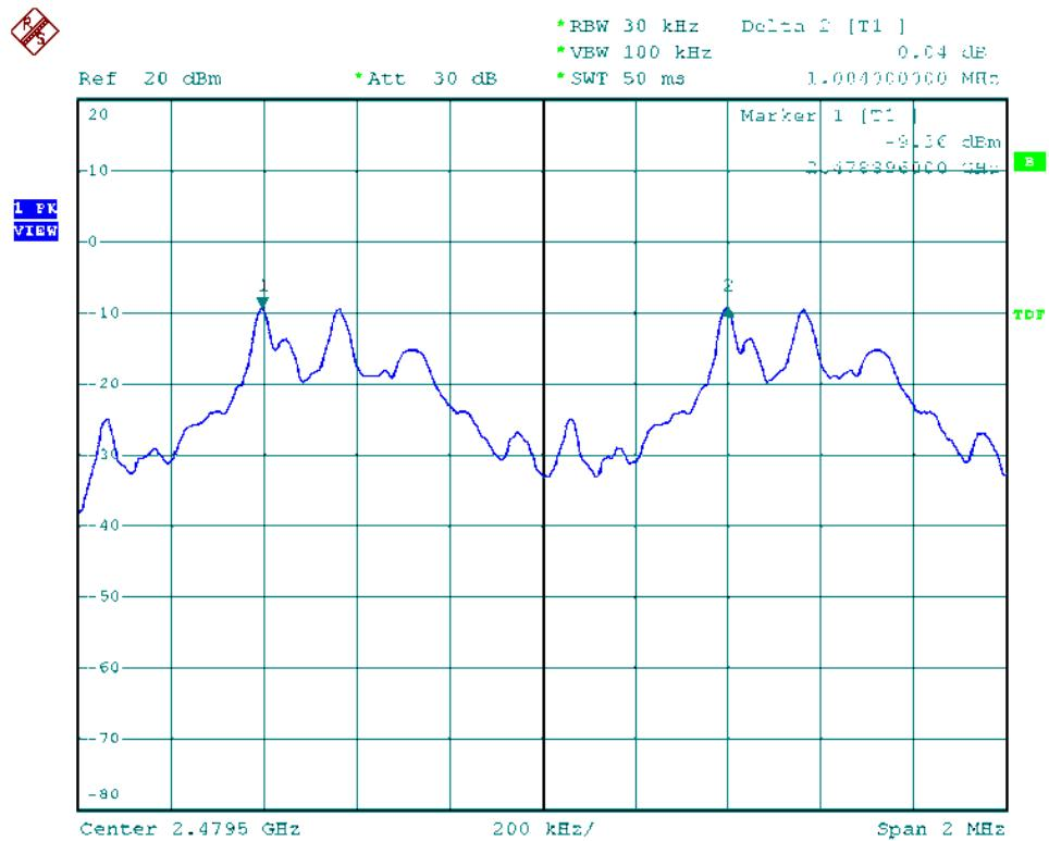
Modulation Standard:  $\pi/4$ -DQPSK (2Mbps)
