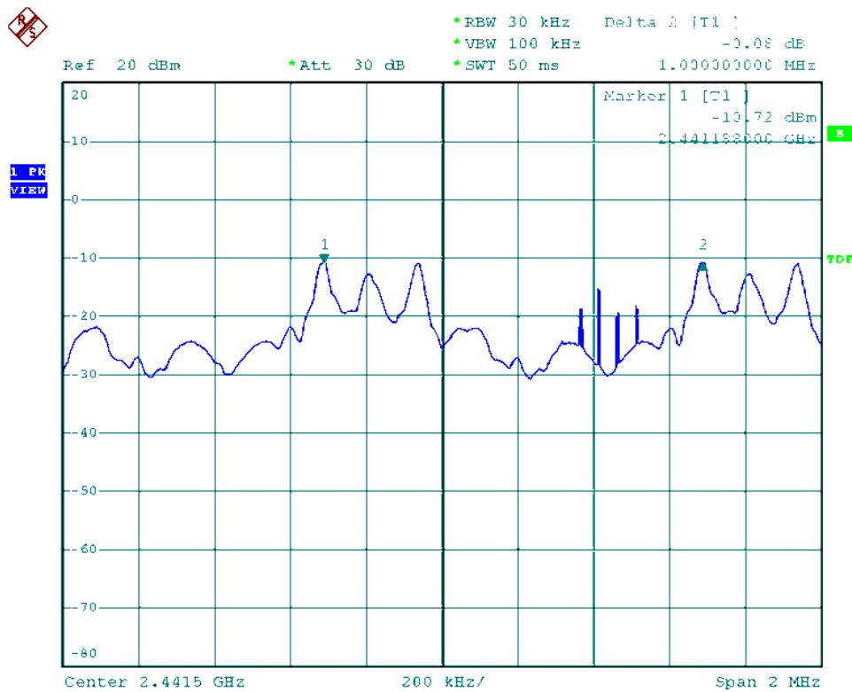
Modulation Standard:  $\pi/4$ -DQPSK (2Mbps)
