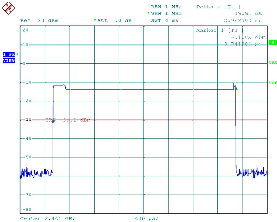
Modulation Standard:  $\pi/4$ -DQPSK (2Mbps)
