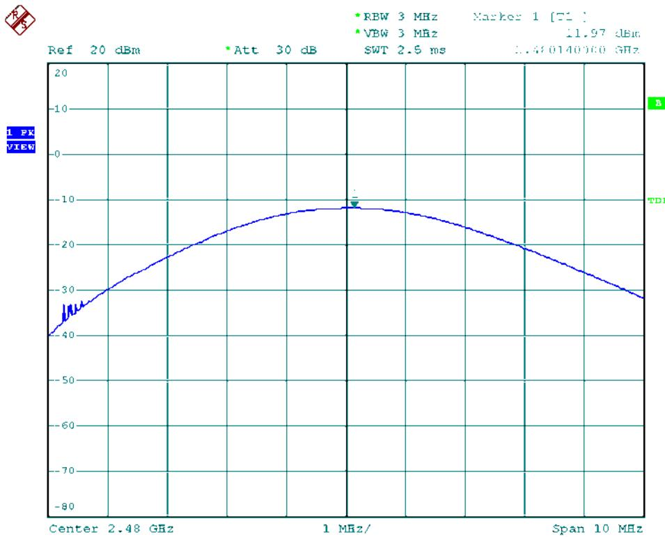
Modulation Standard:  $\pi/4$ -DQPSK (2Mbps)
