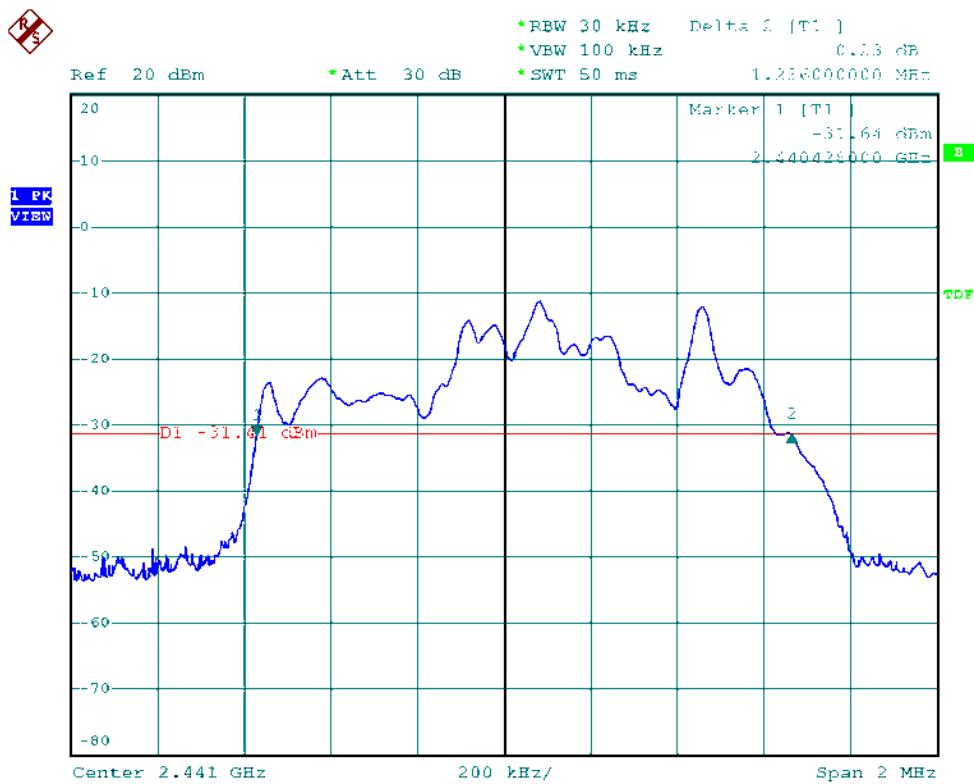
Modulation Standard:  $\pi/4$ -DQPSK (2Mbps)
